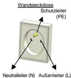
3. Zum Testen des Auslösens des FI-Schutzschalters 30 mA, steckt man das Testgerät an die Wandsteckdose an und prüft, ob die Verkabelung OK ist. Dann drückt man auf den Knopf zum Auslösen eines Fehlerstroms (< 3 s). Wenn der FI-Schutzschalter richtig funktioniert, unterbricht er die Stromversorgung. Wenn der Schutzleiter fehlt, kann der FI-Schutzschalter den Strom nicht unterbrechen.
