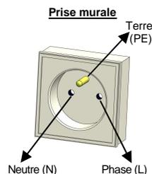
3. Pour tester le déclenchement du disjoncteur différentiel 30 mA, branchez le testeur dans la prise murale et vérifiez que le câblage soit correct. Appuyez sur le bouton de déclenchement de courant de fuite (< 3 s). Si le disjoncteur différentiel fonctionne correctement, il va couper le courant. Si la connexion de terre est absente, le disjoncteur différentiel ne pourra pas couper le courant.
