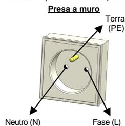
3. Per testare lo scatto dell'interruttore differenziale 30 mA, inserite il tester nella presa a muro e verificate che il cablaggio sia corretto. Premete il pulsante di scatto della corrente di fuga (< 3 s). Se l'interruttore differenziale funziona correttamente, interromperà la corrente. Se il collegamento di terra è assente, l'interruttore differenziale non potrà interrompere la corrente.
