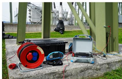
Set mit komplettem Zubehör in einem tragbaren IP67-geschützten Gehäuse für den Feldtransport.
