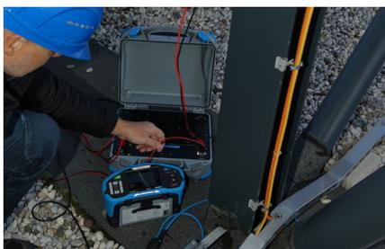
Flexklemmen messen selektive Ströme zur Erde während des erzeugten Impulses.
