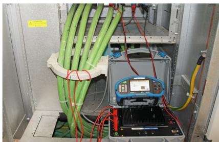
Das Gerät misst die Kombinationszeit (ELR + Schutzschalter) vom Anlegen des Stroms (Iset) bis zur im AUS-Zustand des Schutzschalters erfassten Änderung.
