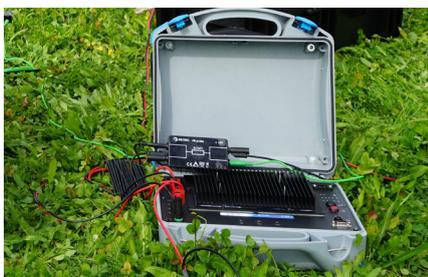
Körperwiderstands-simulation mit 1 kOhm Adapter A1597 zur korrekten Berechnung der Berührungsspannung.
