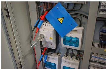
Vierleiterverbindung mit getrennten Prüfklemmen zur Vermeidung von Serienwiderständen und schlechten Verbindungen. Eine Kompensation der Messleitungen ist nicht erforderlich.
