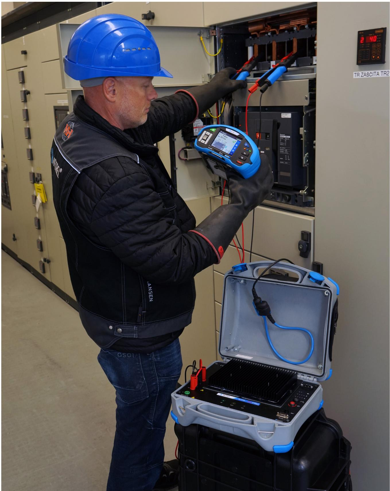
Automatische Auslöseschutz-Prüfung bei Störungen an Transformatoren, Generatoren, Turbinen, Schützen, Verteilern und Schaltanlagen, wenn die energetischen Lasten und Schutzquellen über 200 A eine präzise, robuste und genaue Messmethode zur Auswertung der Ergebnisse für die Erstinspektion und die regelmäßige vorbeugende Wartung oder schnelle Fehlersuche auf jeder industriellen Plattform erfordern.
