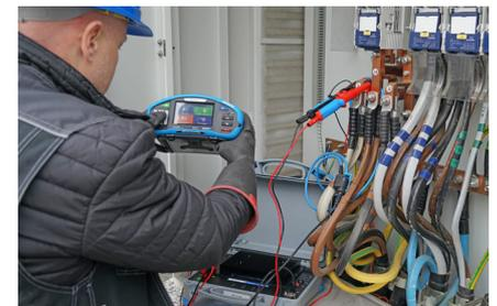
An einen externen Ausgang angeschlossene Flexklemmen für den Einsatz an Hochstromschienen und leistungsstarken Leitern mit großem Querschnitt.
