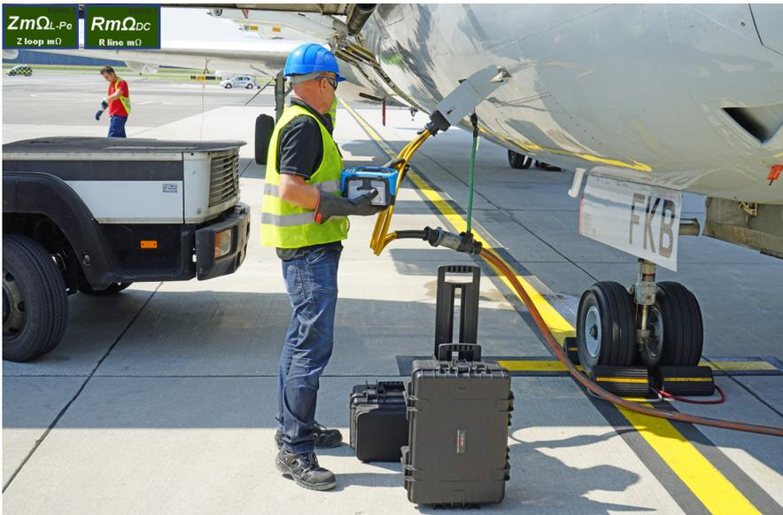
Der Einsatz unserer Lösung parallel zu bestehenden Prüfverfahren mit Lastbänken ermöglicht eine umfassende Bewertung potenzieller Fehler und Störungen an spannungsführenden Stromkreisen aus verschiedenen Quellen von 28 V DC bis 420 Hz 800 V AC. Die Qualität der Motor-, Generator- oder Transformatorwicklungen kann mit der Vierdrahtmethode bewertet werden, was eine genaue Bewertung von Stromquellen mit einer Leistung von bis zu 500 kVA ermöglicht.
