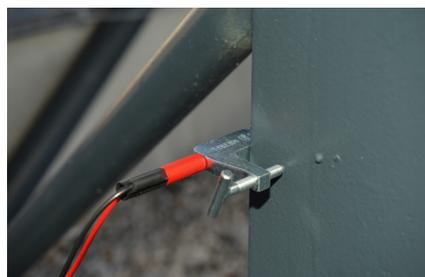
Eine solide G-Klemme verbindet die Messleitungen durch lackierte oder verrostete Oberflächen, um den Hochstrom auf geerdete Leitungen zu führen.
