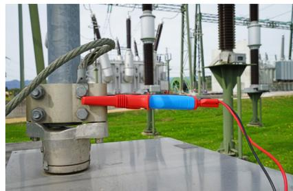
Kelvin-Klemmen gewährleisten eine solide 4-Draht-Verbindung für zuverlässige Ergebnisse.
