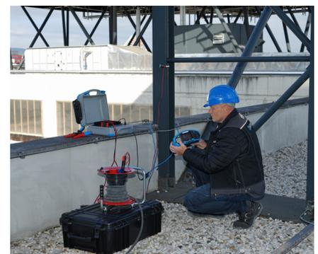
Körperwiderstands simulation mit 1kOhm Adapter A1597 zur korrekten Berechnung der Berührungsspannung.
