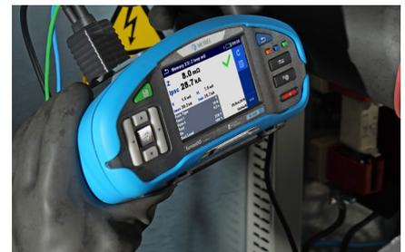
Impedanz mit einer Auflösung von 1mOhm detaillierte Auswertung des  $I_{sc\ min}$ ,  $I_{sc\ max}$  und Z HOT des Transformators basierend auf der Überhitzungsreserve.
