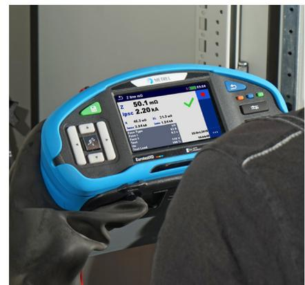
Prüfung der Schleifenimpedanz eines 400 Hz AC 110 V Erdungsnetzteils unter Spannung. Die Hi-Power-Last ist während der Testphase mit dem GPU-Kreis verbunden. Der gemessene Spannungsabfall und Laststrom ergibt das Ergebnis einer möglichen Fehlkontakt- und Kurzschlussstromberechnung, um einen geeigneten Sicherungsschutz zu ermitteln.
