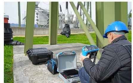
Referenzpunkt mit G-Klemme am Gitteranschluss zur Verbesserung der Ergebnisstabilität.
