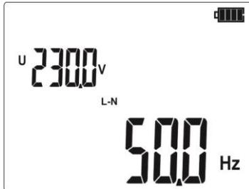
Messergebnis ablesen: die Spannung auf dem Behelfsfeld der Anzeige, die Frequenz auf dem Hauptfeld.
