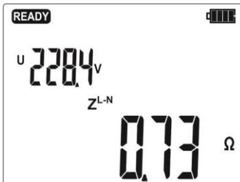
Hauptmessergebnis ablesen: Impedanz der Kurzschlußschleife  $Z_S$  sowie die Netzspannung im Moment der Messung.
