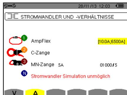
Abbildung 26: Bildschirm Stromwandler und -übersetzungsverhältnisse im Menü Stromwandler und Übersetzungsverhältnisse
