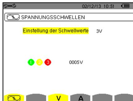
Abbildung 29: Bildschirm Spannungsgrenzwerte im Menü Transienten-Modus
