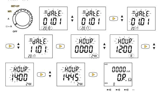
Calibration automatique / Automatic calibration / Automatische Kalibrierung / Calibrazione automatica / Calibración automática / 日期和时间
