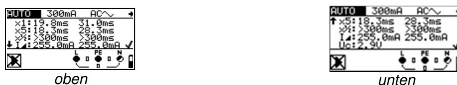
Abbildung 5.22: Die Taste HELP wechselt zwischen dem oberen und unteren Teil des Ergebnisfeldes hin und her.
