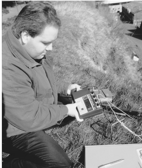
Üblicher Einsatz eines digitalen Megger Erdungswiderstandsmessgerätes zur Durchführung von Spannungsabfallprüfungen
