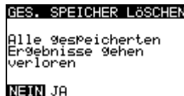
Abbildung 6.6: Gesamten Messwertespeicher löschen
