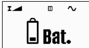
Bild 3.9 Zustand der Batterie nach Drücken von START
