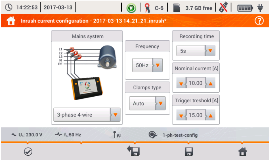
Abb. 4. Ansicht zur Konfiguration des Einschaltstromes
