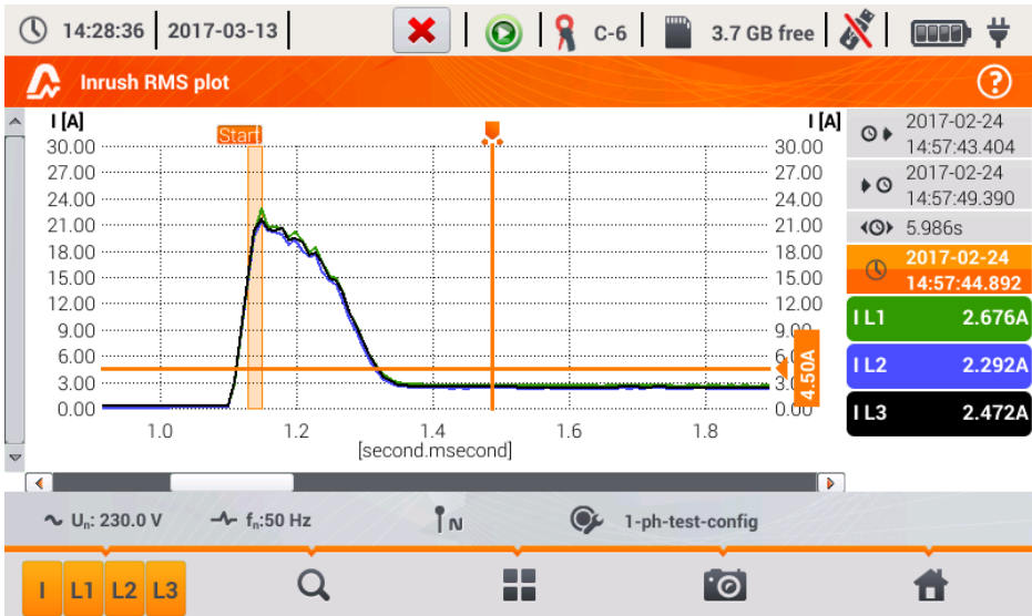
Abb. 8. Einschaltstrom Analyse – RMS Plot
