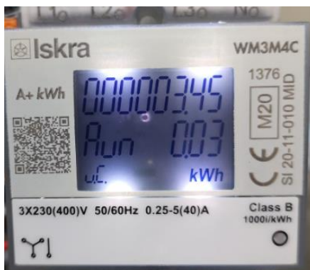
Abbildung 3. Ladende Energie wird im LCD vom Zähler und der öffentliche Schlüssel als QR-Code rechts neben dem LCD-Feld vom Zähler angegeben
