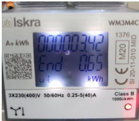
Abbildung 2. Geladene Energie wird im LCD vom Zähler und der öffentliche Schlüssel als QR-Code rechts neben dem LCD-Feld vom Zähler angegeben
