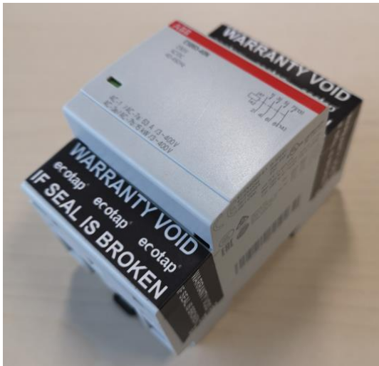
Abbildung 25. Lage des Siegelaufkleber auf dem Relais
