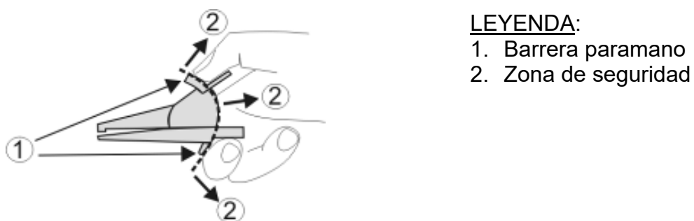
Fig. 2: Descripción de los terminales de medida
