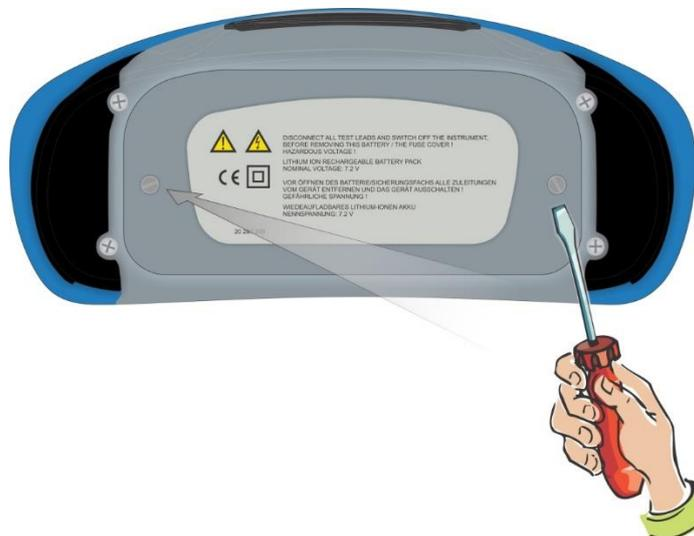
Abbildung 14.1: Position der Schrauben zum Öffnen des Batterie-/Sicherungsfachs
