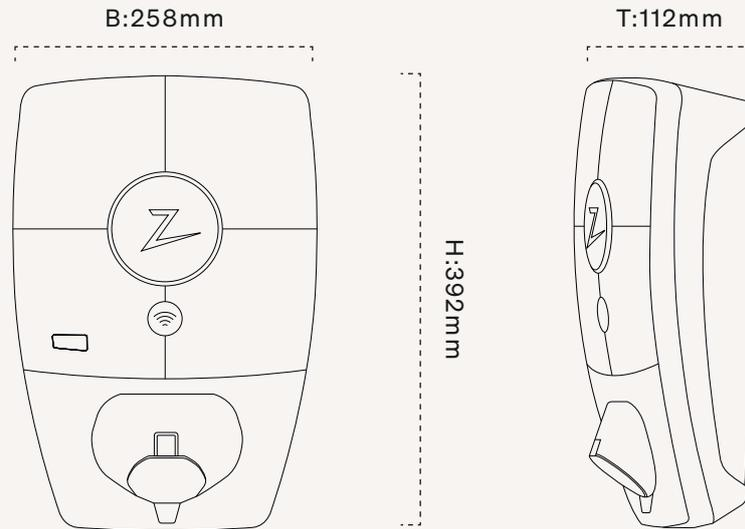
Zaptec Pro ist eine Wand- oder Säulenladestation mit Wechselstrom nach IEC 61851-1, EVSE-Modus 3.
