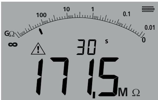
**Hinweis:** Je nach Auswahl wird die Messung bei 15 oder bei 30 Sekunden intern aufgezeichnet. Der aufgezeichnete Wert wird nicht automatisch gespeichert. Zum Speichern drücken Sie bitte die SPEICHERN- (SAVE)-Taste, NACHDEM die DAR-Messung abgeschlossen ist (siehe Abschnitt 9.3.3).
