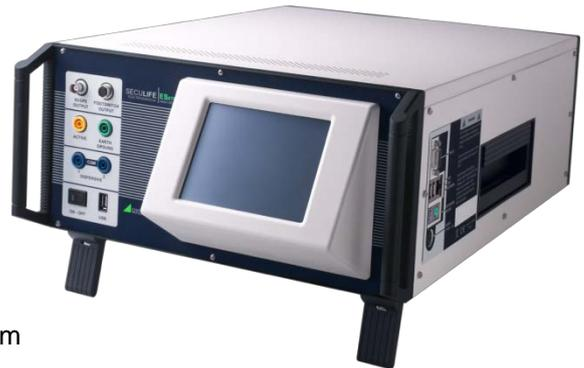
Durch den Gebrauch von internen, induktionsfreien Präzisions-Prüflasten im Bereich von 0  $\Omega$  bis 6400  $\Omega$  in bisher nicht erhältlichen 1  $\Omega$  Schritten, bietet der SECULIFE **ESPRIME** für Krankenhäuser und Hersteller die benötigte Kompatibilität.
