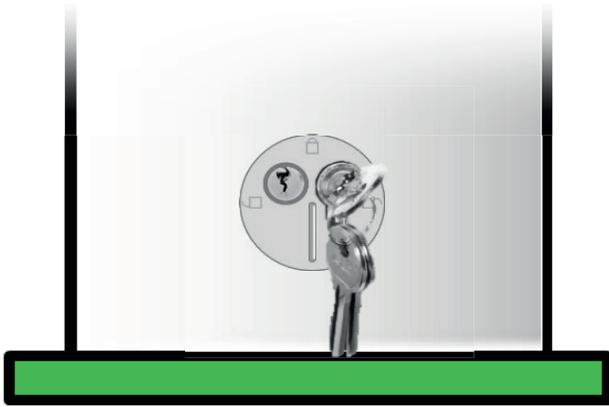
Nach dem Entriegeln der Verriegelung kann die Frontabdeckung (mit Schloss) von der Ladestation getrennt werden.
