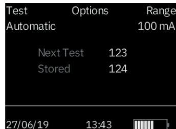
In diesem Bildschirm werden Informationen wie verbleibende Akkuladung, Indexnummer der nächsten Prüfungen, Anzahl der bereits gespeicherten Prüfungen sowie das aktuelle Datum und die aktuelle Uhrzeit angezeigt.
