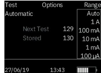
DLRO10X misst mit einem Prüfstrom zwischen 100 µA und 10 A den Widerstand des zu prüfenden Gegenstands. Bei Einstellung auf AUTO wählt DLRO10X den Strom entsprechend dem erkannten Widerstand. (siehe Spezifikationen, Bereiche)
