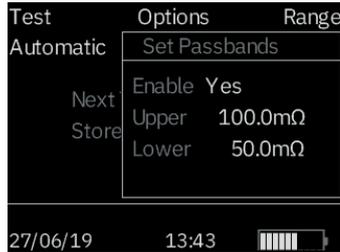
Mit dieser Option können Sie die oberen und unteren Grenzwerte festlegen, zwischen denen der Durchschnittswert der Prüfergebnisse liegen muss, wenn er als „Bestanden“ (GRÜN) signalisiert werden soll. Messwerte außerhalb dieser Grenzwerte werden als Nicht bestanden (ROT) signalisiert.
