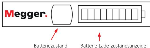
Auf der Vorderseite des Batteriemoduls befinden sich einer Tasten und eine LED-Anzeige mit 10 Segmenten.
