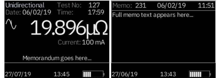
Am unteren Rand des Messbildschirms wird ein mit der Prüfung verbundenes Memo angezeigt. Andernfalls wird in der Prüfung „Platz für Memorandum ...“ angezeigt, was bedeutet, dass diesem Ergebnis keine Anmerkungen beigefügt sind.
