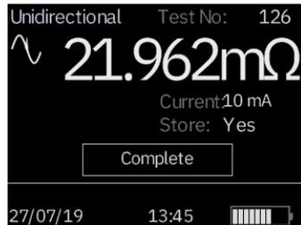
Am Ende jeder Prüfung (mit Ausnahme einer Prüfung im Dauermodus). Sie können die Option, ob Sie Prüfungsergebnisse speichern wollen oder nicht, ändern, indem Sie die Option SPEICHERN auf JA oder NEIN setzen. Wählen Sie die gewünschte Option mit der Cursorsteuerung (NACH OBEN/UNTEN) aus. Dadurch wird die Standardeinstellung unter Optionen, Speicherung nur für eine Prüfung außer Kraft gesetzt.
