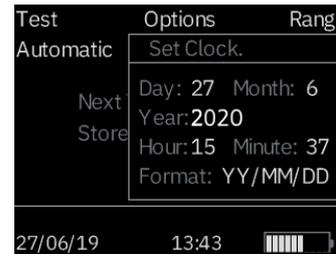
Das untere JJ/MM/TT zeigt das aktuelle Datumsformat an. Durch Drücken der Pfeiltaste nach oben werden die verfügbaren Optionen TT/MM/JJ, MM/TT/JJ oder JJ/MM/TT angezeigt.
