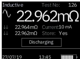
Eine Meldung STROMFLUSS wird angezeigt, wenn nach Abschluss einer Prüfung noch ein Strom größer als 1 mA fließt. Dies deutet darauf hin, dass eine induktive Last getestet wurde und sich noch entlädt. Trennen Sie die Stromschleife nicht, während die Entladewarnung angezeigt wird.
