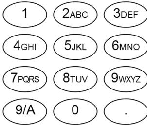
Durch Drücken der blauen 9/A-Taste wird die Funktion der Tastatur zwischen oberem/unterem alphanumerischen und dem numerischen Modus geändert.
