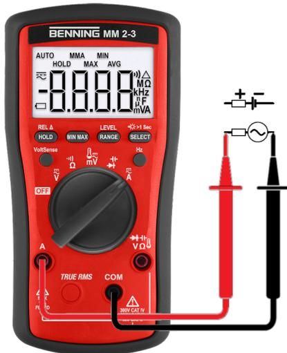
Abb. 10: Strom- oder Frequenzmessung
