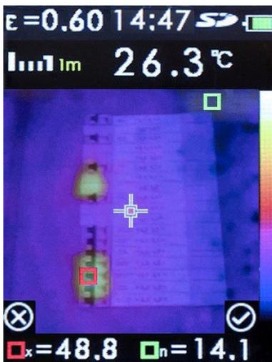
Entriegeln und öffnen Sie die Objektivabdeckung. Richten Sie die Kamera auf das Objekt oder den Untersuchungsbereich und drücken Sie den Messauslöser.
