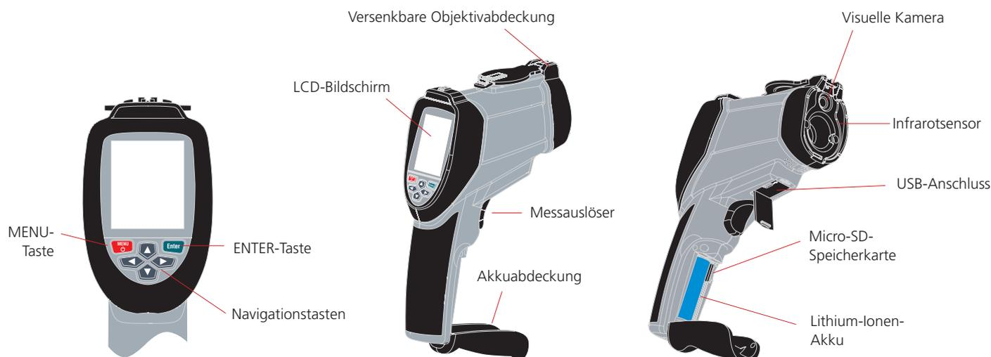
**Hinweis:** Vergewissern Sie sich vor der Verwendung der Kamera, dass die Micro-SD-Karte im Kartensteckplatz im Batteriefach eingesetzt wurde. Das SD-Kartensymbol wird auf dem LCD-Bildschirm oben links neben dem Batteriesymbol angezeigt.
