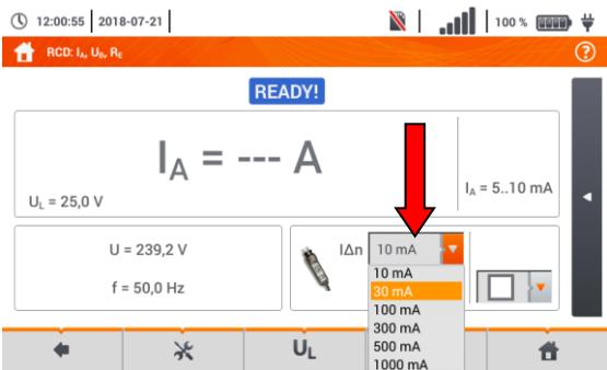
Die Beurteilung der Funktionsfähigkeit richtet sich nach dem Nennauslösestrom des RCD.
