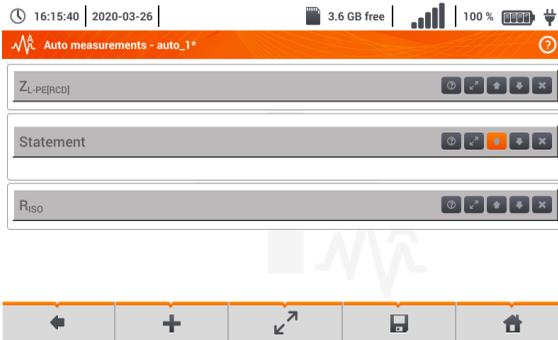
Die Reihenfolge der Schritte wird mit den Tasten geändert. Der Schritt wird mit der Taste gelöscht.
