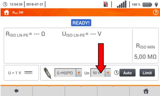
Wählen Sie gewünschte Prüfspannung **Un**...
