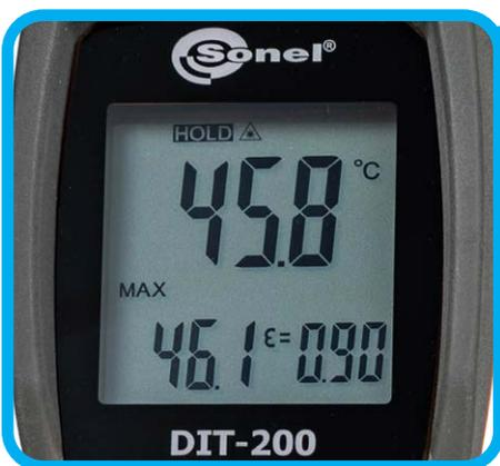
**Spezielle Funktionen** unterstützen Messungen. Pyrometer zeigen Maximal-, Minimal-, Differenz- und Durchschnittstemperaturen an. Darüber hinaus kann der Benutzer Alarmschwellen für die Hoch- und Niedrigtemperatur einstellen.
