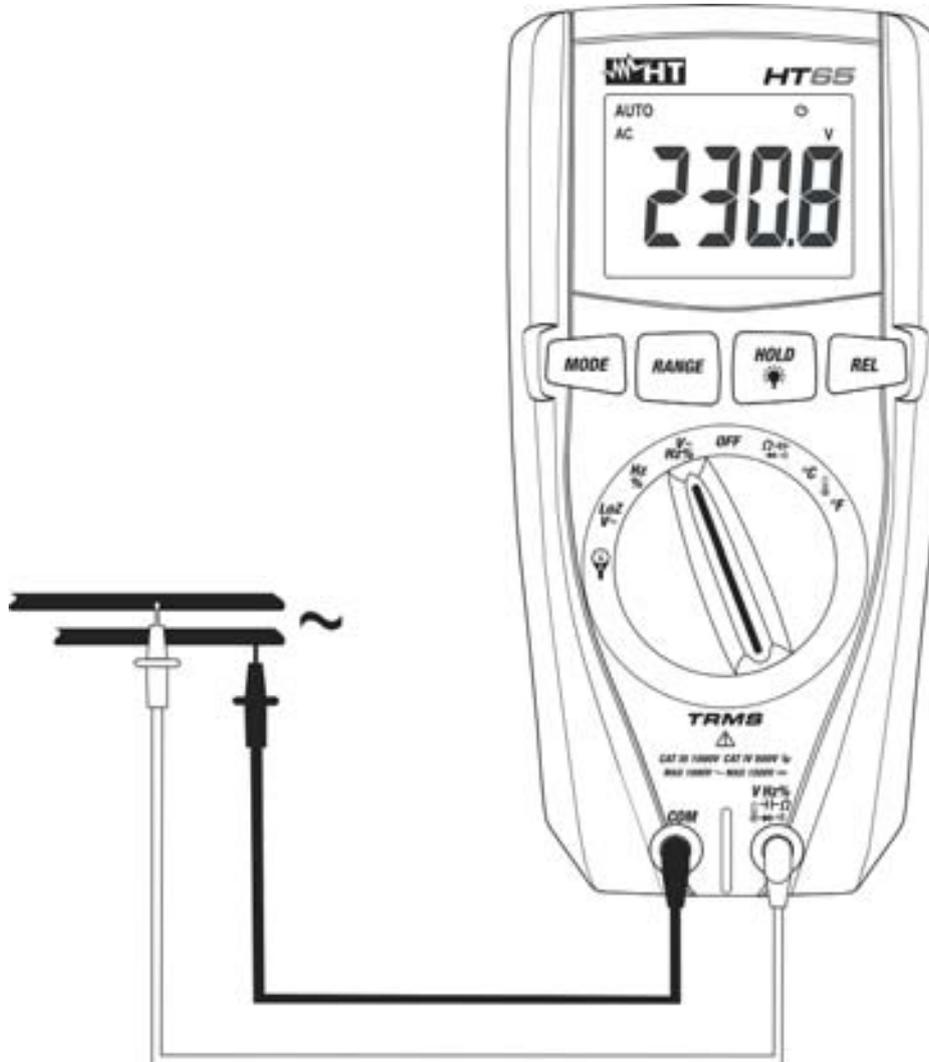
Abb. 3: Verwendung des Gerätes für AC Spannungsmessung
