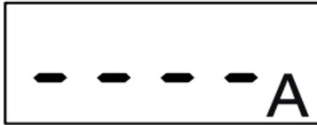
Bei zu steil ansteigenden Signalen bzw. mit zu hohem Scheitelfaktor zeigt das Gerät OL an.
