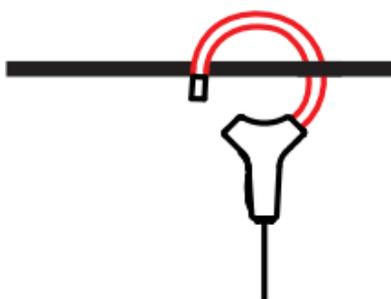
Afin d'optimiser la qualité de la mesure, il convient de centrer le conducteur dans le tore et de donner au tore la forme la plus circulaire possible.
