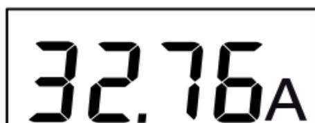
Si la mesure dépasse la capacité d'affichage (400 A), l'appareil affiche 399.9 clignotant.
