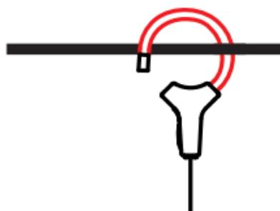
Für optimale Messergebnisse muss der Leiter mittig in der Messschleife ausgerichtet sein, die Messschleife selbst muss so kreisförmig wie möglich gelegt werden.
