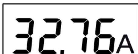
Se la misura supera la capacità di visualizzazione (400 A), lo strumento indica 399.9 (lampeggio).
