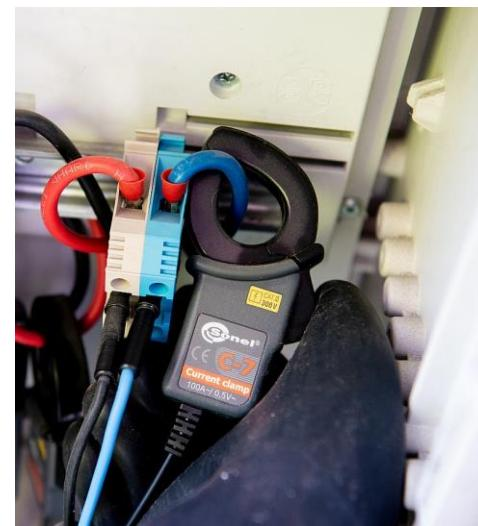
El hueco (formado de las superficies del núcleo) debe mantenerse perfectamente limpio.
