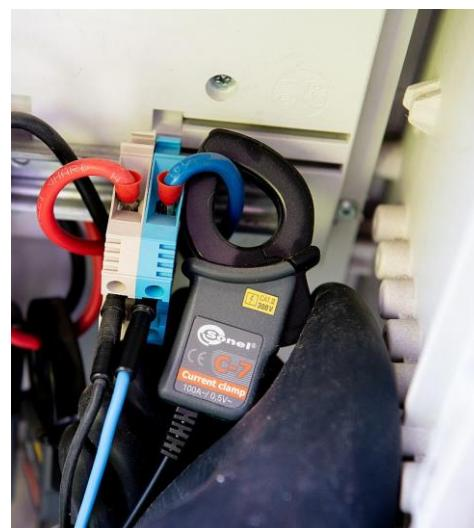
Szczelina (utworzona z powierzchni czołowych rdzenia) powinna być utrzymywana w idealnej czystości.
