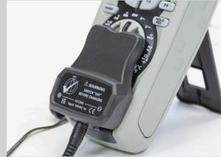
3. Schließen Sie dann den Adapter an das Netzteil an. Ein Aufladesymbol wird angezeigt
