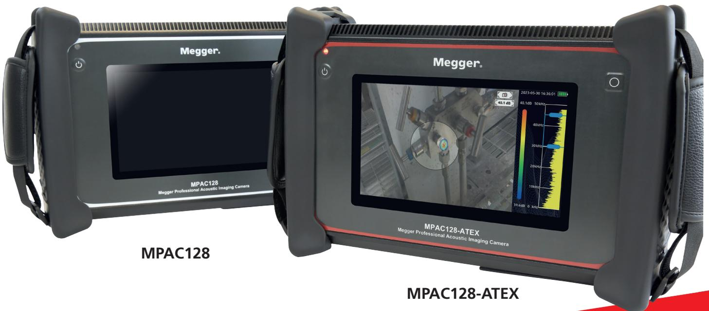
Ein Kernbestandteil akustischer Kameras ist eine Reihe von Mikrofonen. Die Kameras für akustische Bildgebung von Megger verfügen über 128 Mikrofone. Die Mikrofone nehmen Geräusche von Gaslecks oder Teilentladungen im hörbaren und im Ultraschallspektrum auf, wobei die Signalverarbeitung zur Unterdrückung unerwünschter Geräusche verwendet wird. So reagiert die Kamera nur auf vom Fehler stammende Geräusche.
