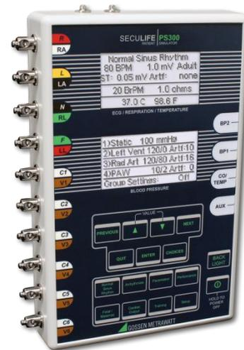
Der SECULIFE PS300 ist ein einfach zu bedienender Patientensimulator bei dem über ein Grafikdisplay alle Parameter angewählt werden können. Autosequenzen für BDM sowie Druck können gewählt werden. 10 Patientenanschlüsse stehen bereit. Eine Erweiterung um eine SpO2 Funktion ist problemlos möglich. 2 Kanäle für Blutdruck sowie 49 Arrhythmien stehen zur Verfügung.
