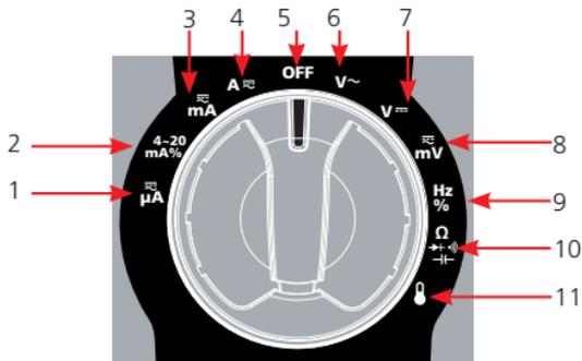
Drehen Sie den Drehschalter, um eine Messfunktion auszuwählen.
