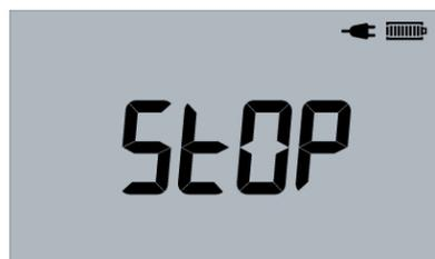
Die Prüfung wird vom Anwender gestoppt, indem die TEST-Taste gedrückt wird.
