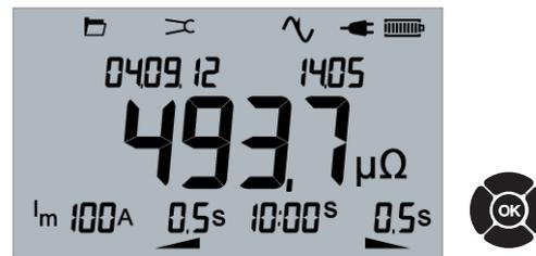
Drücken Sie "OK", um das Ergebnis mit mehr Details anzuzeigen. Drücken Sie "OK", um auf das vorherige Display zu gelangen, das die Slotnummern angibt.
