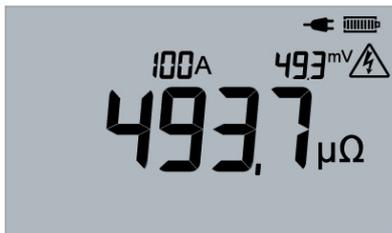
Das Display zeigt den Strom, der durch den Prüfkörper fließt, die gemessene Spannung und den errechneten Widerstand an. Wenn der erforderliche Strom nicht erreicht wird, blinkt der Stromwert auf.
