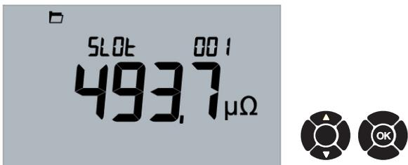
Scrollen Sie nach oben oder unten durch die Ergebnisse mit Slotnummer. Drücken Sie "OK", um die Ergebnisse anzuzeigen.
