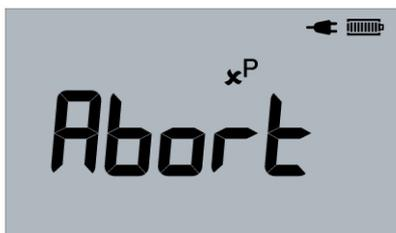
Prüfungsabbruch – Eine Reihe von Umständen können dazu führen, dass die Prüfung abgebrochen wird. Dieses Beispiel zeigt eine schlechte Verbindung.
