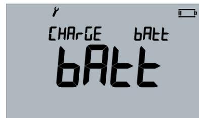
Schalten Sie den Wechselstrom wieder an. Das Menü schaltet automatisch zum nächsten Gegenstand um und das Batterie-Symbol zeigt den Ladezyklus in einer Animation an.
