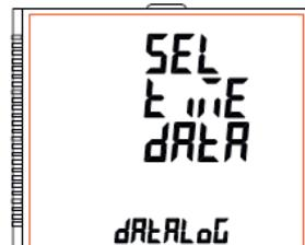
Durch Drücken der Taste "AUF" gelangen Sie in das Menü "Datenloggerprofil laden" (siehe Abschnitt 7.2.5.3) und durch Drücken der Taste "AB" gelangen Sie in das Menü "Ereignisbasiertes Datenlogger-System" (siehe Abschnitt 7.2.5.1).
