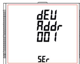
Drücken Sie die Taste "➡ AUF", um zum Bildschirm "RS 485 Baud Rate" (siehe Abschnitt 7.2.2.2) zu gelangen, oder drücken Sie die Taste "⬅ AB", um zum Bildschirm "Beenden Kommunikationsparameter" zu gelangen (siehe Abschnitt 7.2.2.4).
