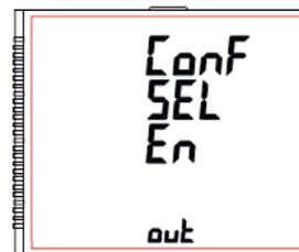
Drücken Sie die Taste "➔ AUF", um die Auswahl zu bestätigen und zum Menü "Einschaltverzögerung Timer" (siehe Abschnitt 7.2.4.1.1.3.3) zu gelangen, und drücken Sie die Taste "➔ AB", um zum Menü "Anzahl der Zyklen" (siehe Abschnitt 7.2.4.1.1.3.1) zu gelangen.
