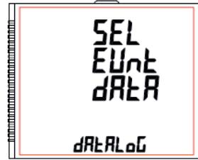
Durch Drücken der Taste "AUF" gelangen Sie in das Menü "Zeitbasiertes Datalogger-Signal" (siehe Abschnitt 7.2.5.2) und durch Drücken der Taste "AB" gelangen Sie in das Menü "Optionsauswahl Datenlogger beenden" (siehe Abschnitt 7.2.5.4).
