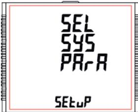
Mit dieser Anzeige werden die verschiedenen Systemparameter gewählt, beispielsweise "Systemtyp", "Stromwandlerverhältnis", "Spannungswandlerverhältnis".
