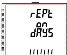
Durch Drücken der Taste "➡ AUF" wird die Auswahl bestätigt und Sie gelangen in das Menü "Konfiguration Relais" (siehe Abschnitt 7.2.4.1.1.4.2) und mit der Taste "➡ AB" gelangen Sie in das Menü "RTC Relais" (siehe Abschnitt 7.2.4.1.1.4).
