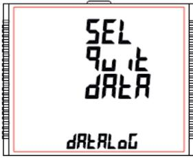
Drücken Sie die Taste "➔ AUF", um zum Menü "Ereignisbasiertes Datenlogger-System" (siehe Abschnitt 7.2.5.1) zu gelangen, und drücken Sie die Taste "➔ AB", um zum Menü "Belastungsprofil Datenlogger-Setup" zu gelangen (siehe Abschnitt 7.2.5.3).
