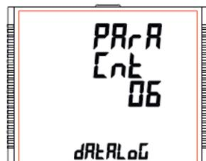
Durch Drücken der Taste "▶ AUF" wird die Auswahl bestätigt und der Bildschirm "Parameterauswahl" (siehe Abschnitt 7.2.5.2.4) und durch Drücken der Taste "▶ AB" die Auswahl bestätigt und der Bildschirm "Zeitintervallauswahl" angezeigt (siehe Abschnitt 7.2.5.2.2).
