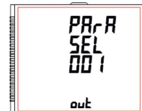
Durch Drücken der Taste "➡ AUF" wird der aktuelle Parameterwert akzeptiert. Bei der Auswahl von den Parameter-Nr. 37/38/39/40/41 als aktuellen Wert wird der Bildschirm "Konfiguration Energiezähler" (siehe Abschnitt 7.2.4.1.2.2) angezeigt. Bei allen anderen Parameter-Nr. als aktuelle Werte führt zur Auswahlanzeige "Parameterkonfiguration" (siehe Abschnitt 7.2.4.1.1.2.5).
