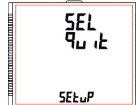
Durch Drücken der Taste "■" wird das Setup-Menü verlassen und der Messbildschirm aufgerufen, von dem aus der Setup-Bildschirm aufgerufen wurde.
