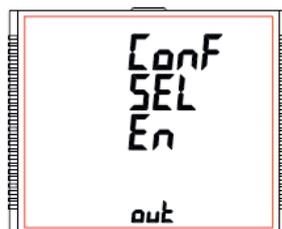
Die Option bestimmt die Relaiskonfiguration im Timer-Modus. Zwei Optionen stehen zur Verfügung:
