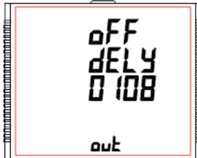
Wenn Sie die Taste "➡ AUF" drücken, wird der Wert bestätigt, und Sie gelangen zum Menü "Beenden Timer" (siehe Abschnitt 7.2.4.1.1.3.5). Durch Drücken der Taste "➡ AB" gelangen Sie zum Menü "Einschaltverzögerung Timer" (siehe Abschnitt 7.2.4.1.1.3.3).
