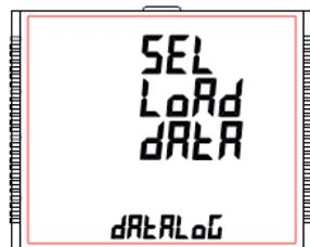
Durch Drücken der Taste "▶ AUF" gelangen Sie in das Menü "Beenden Datalogger-Optionen" (siehe Abschnitt 7.2.5.4) und durch Drücken der Taste "▶ AB" zu "Zeitbasierte Datenlogger-Setup" (siehe Abschnitt 7.2.5.2).
