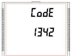
Drücken Sie die Taste "➤ AUF" dann scrollen Sie den Wert der ersten Stelle von 0 bis 9, der Wert geht von 9 auf 0 zurück. Drücken Sie die "➤ AB" dann scrollen Sie den Wert der ersten Stelle von 9 bis 0, der Wert geht von 0 auf 9 zurück.
