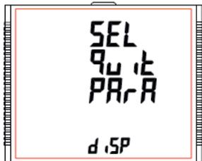
Durch Drücken der Taste "➔ AUF" gelangen Sie zum Bildschirm "Hintergrundbeleuchtung". (siehe Abschnitt 7.2.6.1.1). Durch Drücken der Taste "➔ AB" gelangen Sie zum Bildschirm "Alte Parameter". (siehe Abschnitt 7.2.6.1.4).
