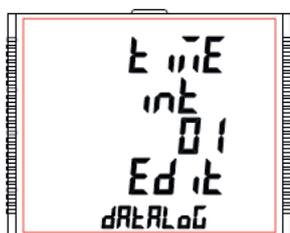
Drücken Sie "■", um ein anderes Zeitintervall einzugeben. Sie werden zur Eingabe der ersten Ziffer aufgefordert. Drücken Sie die Tasten "▶ AUF" und "▶ AB", um den Wert der ersten Ziffer zu scrollen. Drücken Sie die Taste "■", um zur nächsten Ziffer zu gelangen.
