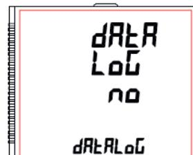
Durch Drücken der Taste "AUF" wird die Auswahl bestätigt und der Bildschirm "Zeitintervallauswahl" (siehe Abschnitt 7.2.5.2.2) angezeigt und durch Drücken der Taste "AB" die Auswahl bestätigt und der Bildschirm "Zeitbasierte Datenlogger beenden" (siehe Abschnitt 7.2.5.2.5) angezeigt.
