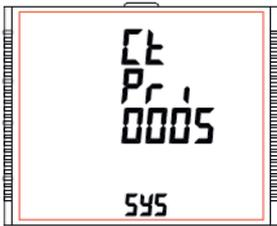
Drücken der Taste "➡ AUF" akzeptiert den gegenwärtigen Wert und führt zum Menü "Stromwandler-Sekundärwert". (Siehe Abschnitt 3.2.1.5).
