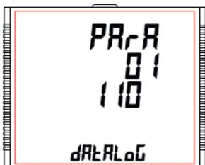
Durch Drücken der Taste "▶ AUF" wird die Auswahl bestätigt und der Benutzer kann mit der Einstellung des nächsten Parameters fortfahren, bis der letzte Parameter eingestellt ist. Anschließend wird der Bildschirm "zeitbasierter Datenlogger beenden" angezeigt (siehe Abschnitt 7.2.5.2.5).
