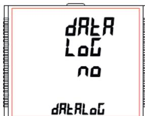
Durch Drücken der Taste "■" kann der Benutzer den Datalogger des Lastprofils starten oder stoppen, indem er mit den Tasten "▶ AUF" und "▶ AB", "JA" oder "Nein" wählt.
