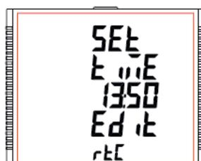
Drücken Sie "■", um 10's für HH einzustellen. Drücken Sie "■", um 1's für HH einzustellen. Drücken Sie "■", um 10's für MM einzustellen. Drücken Sie die Taste "■", und fordern Sie die Stelle von 1 für MM an.
