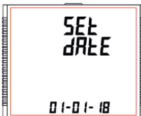
In diesem Bildschirm kann der Benutzer Datum und Uhrzeit für die RTC des Geräts einstellen.
