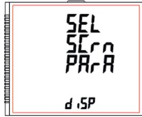
Durch Drücken der Taste "■" kann der Benutzer zum Menü "Auswahl der Bildschirmnummer" wechseln (siehe Abschnitt 7.2.6.1.2.1), während durch Drücken der Tasten "➔ AUF" und "➔ AB" das Menü "Hintergrundbeleuchtung" aufgerufen wird (siehe Abschnitt 7.2.6.1.1.) und das Menü "Kontrast" (siehe Abschnitt 7.2.6.1.3).
