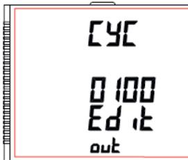
Drücken Sie die Taste "■" und Sie gelangen zur ersten Ziffer. Drücken Sie die Tasten "➔ AUF" und "➔ AB", um die Werte der ersten Ziffer zu scrollen.
