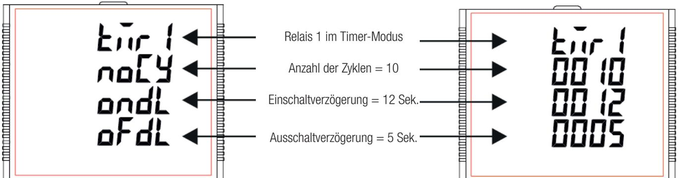
Der Bildschirm zeigt die Anzahl der Zyklen für die Verzögerung des entsprechenden Relais im Timer-Modus. Wenn das Relais im Timer-Modus konfiguriert ist, kann der Timer durch langes Drücken (ca. 3 Sekunden) der Aufwärts-Taste "▲ AUF" eingeschaltet werden, während er in einem der Messbildschirme angezeigt wird.
