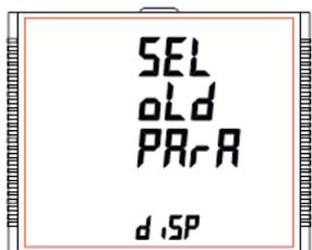
Durch Drücken der Taste "➔ AUF" gelangen Sie zum Bildschirm "Display-Parameter beenden". (siehe Abschnitt 7.2.6.1.5). Durch Drücken der Taste "➔ AB" gelangen Sie zum Bildschirm "Kontrast". (Siehe Abschnitt 7.2.6.1.3).
