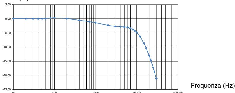
Curva tipica dell'errore di fase a 30 A in funzione della frequenza
