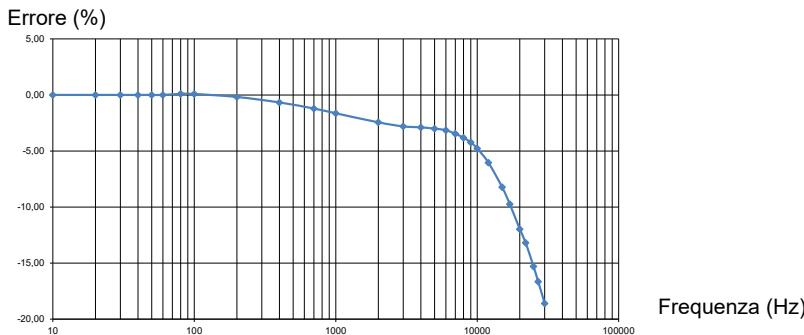
Curva tipica dell'errore di fase a 60 A in funzione della frequenza
