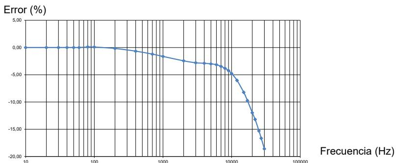
Curva típica del error de fase a 60 A en función de la frecuencia
