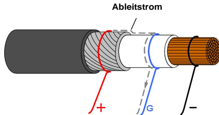
*Dieses Diagramm zeigt den GUARD-Anschluss, der verwendet wird, um Kriechströme an der Kabelisolierung zu verhindern, die sich auf hohe Widerstandsmessungen auswirken könnten.*
