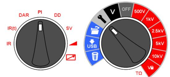
Die DAR- und PI-Timer  $t_1$  und  $t_2$  werden eingestellt, wenn am Testmodus-Drehschalter DAR oder PI ausgewählt wird, wobei sich der mittige Drehschalter in der Einstellungsposition befindet. Zuerst wird der Wert  $t_1$ , dann der Wert  $t_2$  eingestellt. Mit den Aufwärts/Abwärts-Pfeiltasten werden die standardmäßigen  $t_1$ - und  $t_2$ -Werte verändert; die einzelnen Einstellungen werden dann mit OK bestätigt.
