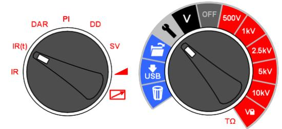
Drehen Sie den mittigen Drehschalter auf die Einstellungsposition. Wählen Sie IR(t) am Prüfmodus-Drehschalter. Standardmäßig blinkt 1:00 Minute und der Benutzer wird aufgefordert, die neue Zeit mit den Aufwärts/Abwärts-Pfeiltasten einzugeben. Drücken Sie OK, um die Prüfdauer einzustellen, und drehen den mittigen Drehschalter auf die gewünschte Prüfspannung. Drücken und halten Sie die Taste TEST, um die Prüfung zu starten.
