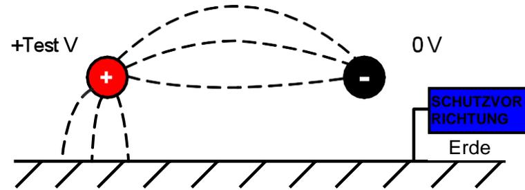
Wenn der Pluspol jedoch geerdet ist, ist die Spannung am Minuspol gleich der Prüfspannung bezogen auf die Erde; dies erhöht den Kriechstrom, was sich nachteilig auf die Messgenauigkeit auswirkt.
