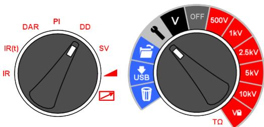
Der Isolierkörper muss anfänglich ausreichend lange aufgeladen werden, d. h., die Entladung und die Polarisierung müssen abgeschlossen sein, damit der verbleibende Strom der Ableitstrom der Isolation ist. Bei Entladung der kapazitiven Komponente klingt der Entladestrom innerhalb weniger Sekunden auf einen konstanten Wert ab. Dieser freigesetzte Absorptionsstrom klingt von einem niedrigen Wert mit einer relativ langen Zeitkonstante bis zu mehreren Minuten ab.
