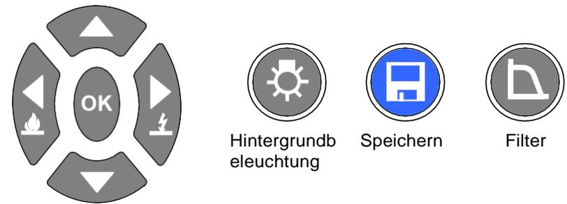
Vier Pfeiltasten und eine OK-Taste erleichtern die Anpassung und Auswahl von Einstellungen, Spannungspegel und Modi. Auswahl der Modi Durchschlag/Burn mit den Rechts/Links-Pfeiltasten. Dedizierte Tasten für die Hintergrundbeleuchtung, Speicherung und Filter.
