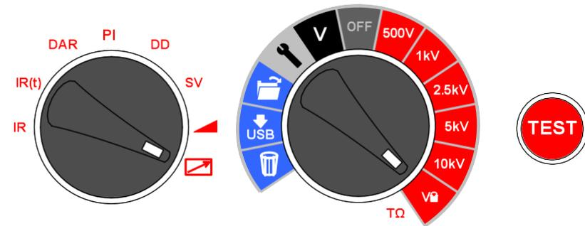
Die Instrumentensteuerung ist benutzerfreundlich. Der mittige Drehschalter enthält eine OFF-Stellung (AUS). Mit dem linken Drehschalter wird der Isolationsprüfartyp ausgewählt. Das Drücken der Taste TEST startet und beendet eine Prüfung. Das Schaubild zeigt die Instrumenteneinstellung für den Fernbedienungsmodus.
