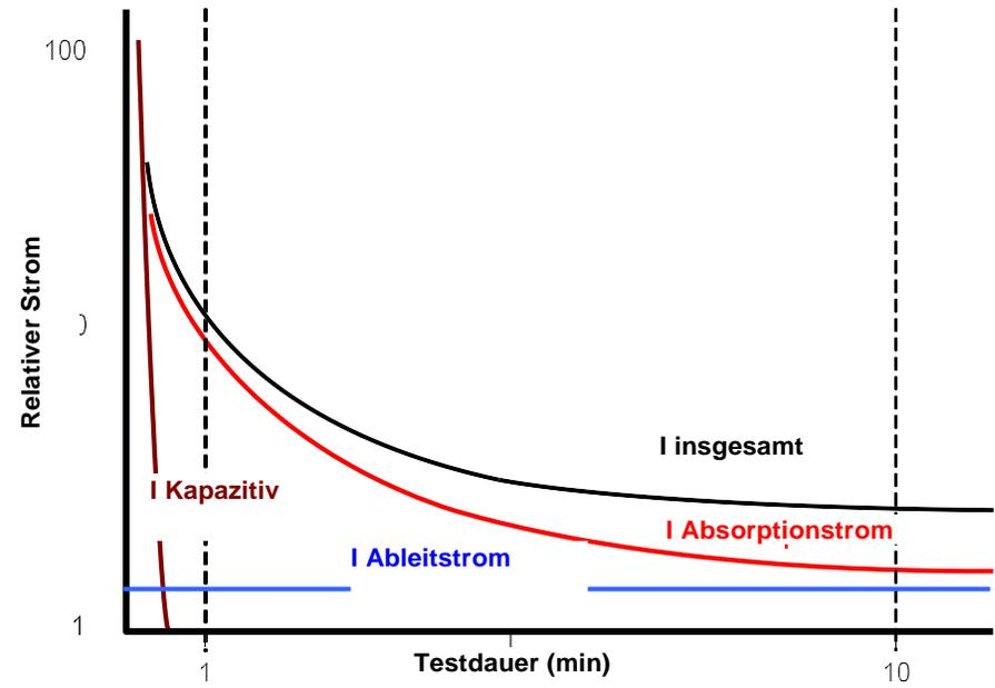
Bei Trockenisolierung ist der Konduktanzstrom vernachlässigbar und der Ableitstrom kann niedrig sein. Dann dominiert der Absorptionsstrom den gemessenen Gesamtstrom.
