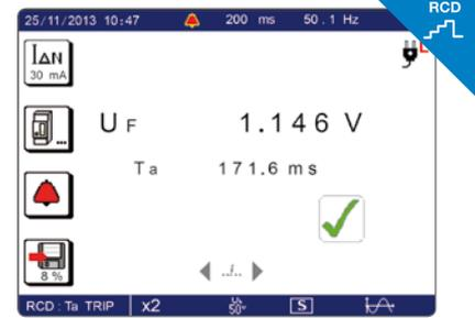
Mit der FI-Schutzschalterprüfung lässt sich auch die Fehlerspannung  $U_f$  berechnen:  $U_f = Z_s \times I_{\Delta n}$ .
