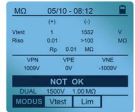
**Überprüfung:** Messung mit sofortigem Ergebnis (OK | NO) des Isolationswiderstands der aktiven Leiter eines Moduls oder eines Strings gemäß der Normenvorschrift IEC/EN 62446, ohne dass ein externer Schalter zum Kurzschließen der positiven und negativen Anschlüsse notwendig ist.
