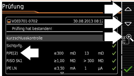
(Berücksichtigung der Betriebsmessabweichung BMU ist abhängig von der Parametereinstellung in der Schalterstellung **SETUP**: Setup 1/3 > Autom. Messungen > BMU berücksichtigt. > ja)
