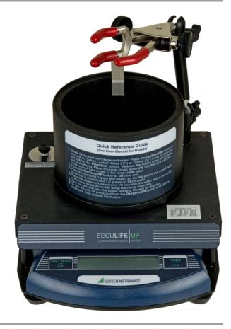
Ultraschall-Wattmeter werden weltweit seit 1977 eingesetzt und stellen einen allgemein akzeptierten Standard zur Dokumentation der Leistung von medizinischen Wandlern dar. Das Modell SECULIFE UP-Ultraschall-Leistungsmesser wurde zur Prüfung von diagnostischen und therapeutischen Wandlern entwickelt.
