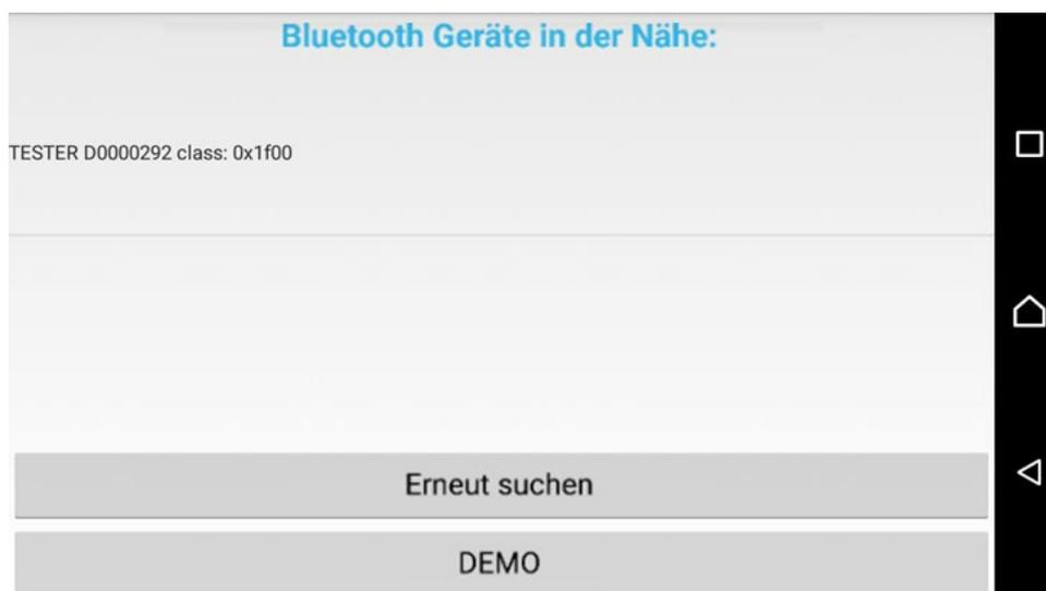
Der Gerätetester meldet sich am Ende der Bluetooth-Suche mit der Seriennummer. Wenn mehrere Gerätetester in der Nähe sind, können auch mehrere angezeigt werden. Geräte, die keine Gerätetester sind, werden in der Liste nicht angezeigt.
