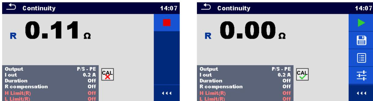
Abbildung 7.21: Nicht kompensiertes und kompensiertes Ergebnis
