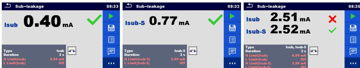
Abbildung 7.45: Beispiele für die Ergebnisse der Teilableitstrom-Messung
