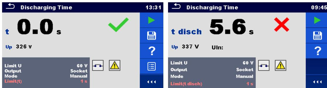
Abbildung 7.66: Beispiele für Messergebnisse für die Entladungsdauer (Ausgang = Buchse)
