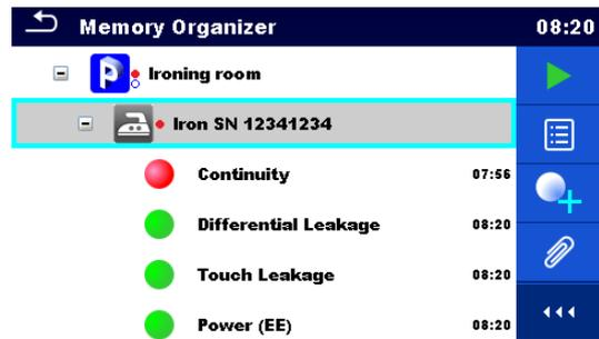
Abbildung 6.6: Status - Abgeschlossene Messungen mit fehlgeschlagenen Ergebnissen
