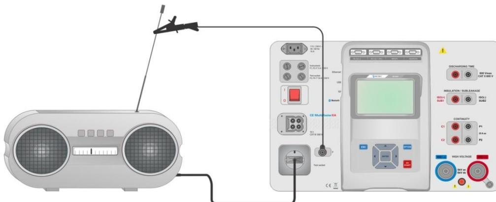
Abbildung 7.44: Teilableitstrommessung, Teilableitstrommessung-S (Buchse)
