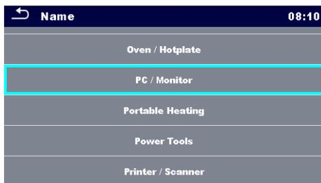
Im Menü zum Bearbeiten von Parametern kann der Wert des Parameters aus einer Dropdown-Liste ausgewählt oder über die Tastatur eingegeben werden. Im Kapitel 5 *Bedienung des Geräts* finden Sie weitere Informationen zur Tastaturbedienung.
