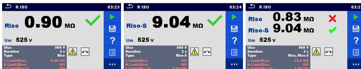
Abbildung 7.40: Beispiele für Ergebnisse von Isolierungswiderstandsmessungen
