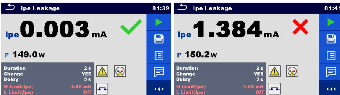
Abbildung 7.51: Beispiele für die Ipe-Ableitstrom-Messergebnisse
