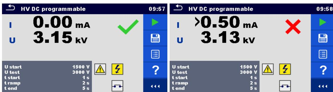
Abbildung 7.35: Beispiele für die Testergebnisse für HS DC programmierbar
