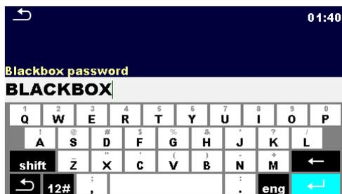
Die Tastatur zum Eingeben eines neuen Black-Box-Kennworts wird geöffnet. Leere Zeichenfolgen deaktivieren das Kennwort.
