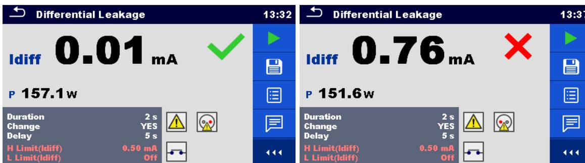
Abbildung 7.48: Beispiele für die Differentialableitstrom-Messergebnisse
