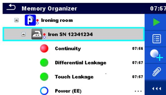
Abbildung 6.5: Beispiel für Status - Nicht abgeschlossene Messung(en) mit fehlgeschlagenen Ergebnissen
