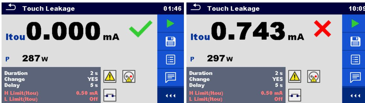
Abbildung 7.54: Beispiele für die Ableitberührungsstrom-Messergebnisse
