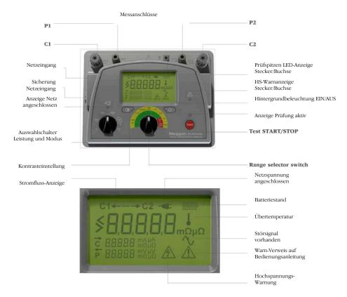
Nach dem Starten einer Prüfung wird der Anwender die Bestätigung der erfolgreichen Durchgängigkeitsprüfung auf dem LCD-Display sehen. Falls die Striche nicht gezeigt werden, die die 1 & 2 C-und/oder P-Kabel verbinden, wurde die Verbindung nicht erkannt.
