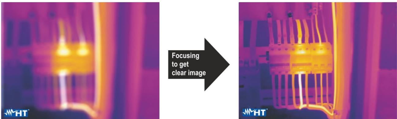
Abb. 8: Scharfstellung des Bildes im Display
