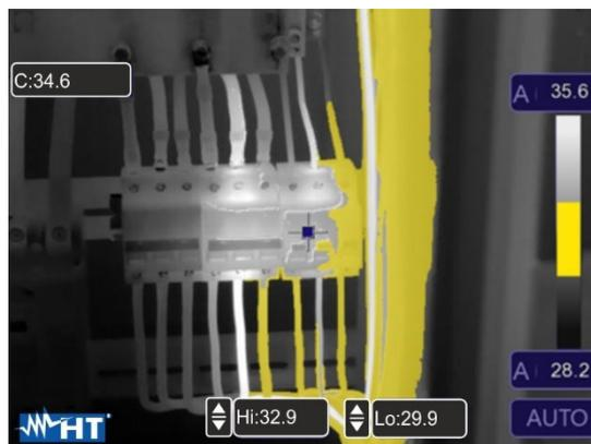
Abb. 43: Auswahl Isothermen-Linie Alarm Temp.-Intervall
