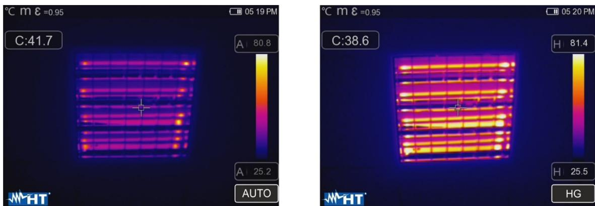
Abb. 46: Einstellung der Modi Automatisch und Histogramm
