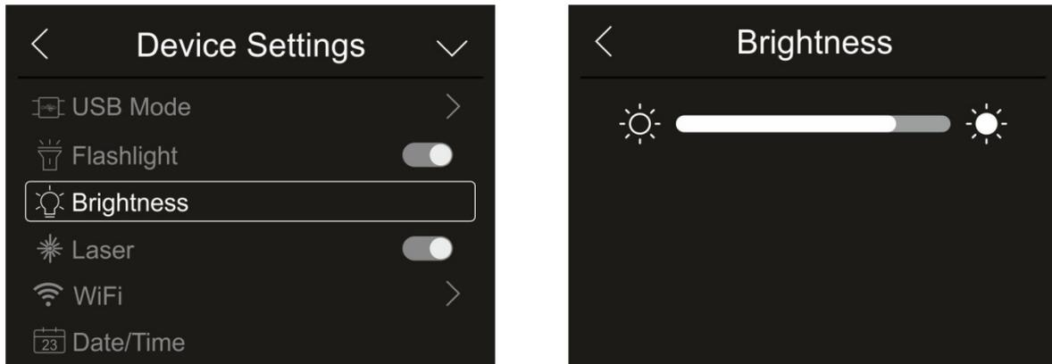
Abb. 15: Einstellung der Helligkeit des Displays
