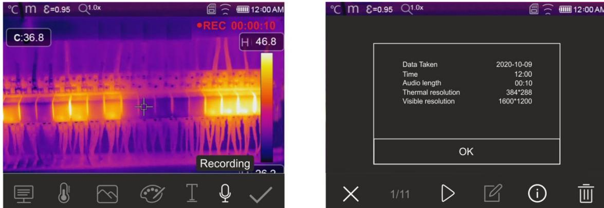
Abb. 50: Einfügen einer Sprachaufzeichnung auf dem Bild
