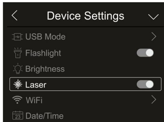
Abb. 16: Aktivierung des Laser-Pointers
