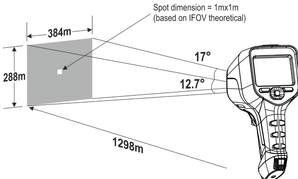
Abb. 53: Darstellung des Sichtfeldes FOV des Geräts THT600
