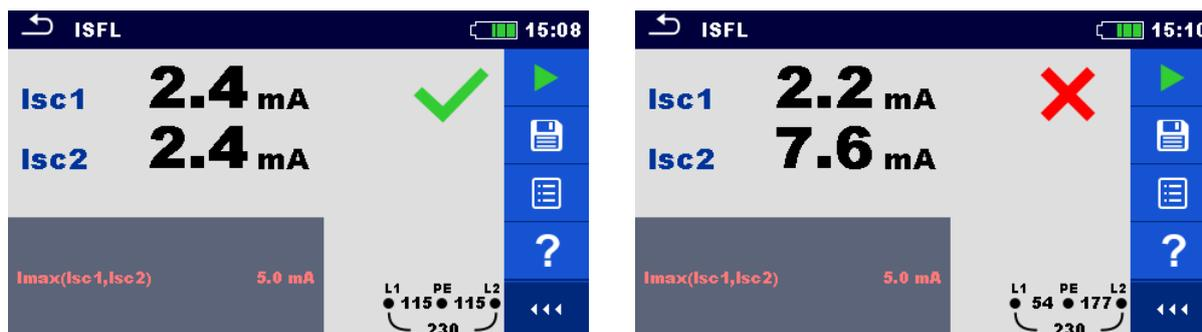
Abbildung 7.96: Beispiel für die Messergebnisse des ersten Fehlerleckstroms
