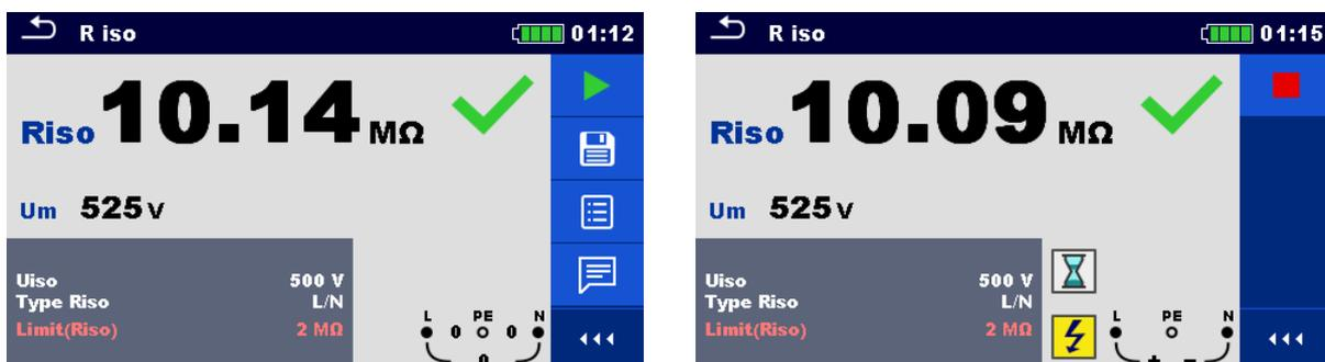
Abbildung 6.1: Aufbau des Einzelprüfungs-Bildschirms am Beispiel einer Isolationswiderstandsmessung
