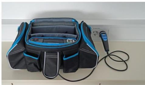
Das Prüfgerät kann auch in der Tragetasche liegend verwendet werden – das Prüfkabel wird über die vordere Öffnung an das Gerät angeschlossen.
