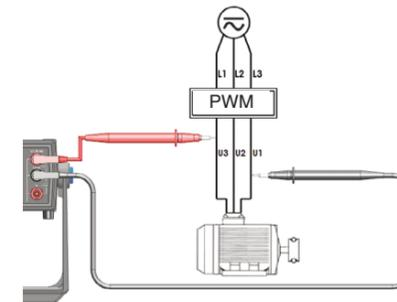
Beispiel: Spannungsmessung an einem Drehzahlregler
