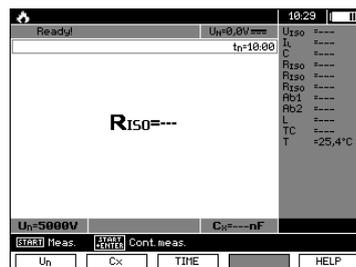
Tasten **F1**  $\left[ \text{Un} \right]$ , **F2**  $\left[ \text{Cx} \right]$  und **F3**  $\left[ \text{TIME} \right]$  verwenden, um die gewünschte Spannung, Kapazität des Prüflings einzustellen. Durchführung ähnlich wie im Kapitel 3.2.2.
