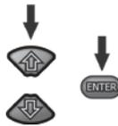
Tasten **↑**, **↓** drücken, um den Wert der Kapazität einzugeben; Bestätigen der Auswahl durch Drücken von **ENTER**. Eingabebereich: von 10 nF bis 990 nF. Liegt der Wert unter 10 nF oder über 990 nF ist die Funktion zur Berechnung der Leiterlänge ausgeschaltet.
