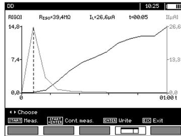
Der Cursor (z. B. der gestrichelten vertikalen Linie) kann durch die Tasten  $\leftarrow$ ,  $\rightarrow$  verschoben werden. Die aktuelle Position des Cursors zeigt den zu diesem Zeitpunkt gemessenen Wert an. Das Messergebnis gibt Hinweise auf den Zustand der Isolation. Zum Vergleichen siehe Tabelle unten:
