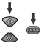
Tasten **↑**, **↓** drücken, um Spannung auszuwählen. Bestätigen der Auswahl durch Drücken von **ENTER**.
