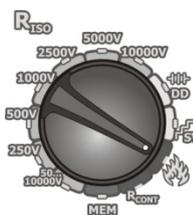
Stellen Sie den Funktionswahlschalter auf die Position . Das Prüfgerät ist im Spannungsmess-Modus.
