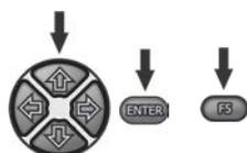
Tasten **↑**, **↓**, **←**, **→** und **ENTER** verwenden um die Einheit zu wählen. Bestätigung durch Taste **F5** **OK**.
