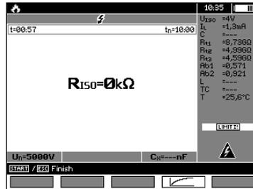
Wenn ein Durchschlag erfolgt, unterbricht das Prüfgerät die Messung nicht (so wie in anderen Messungen). Am Display wird oben das entsprechende Warnsymbol angezeigt.
