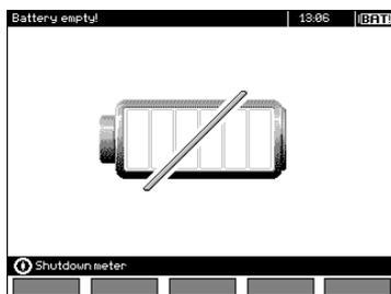
Akku extrem entladen, es können keine Messungen mehr durchgeführt werden.
