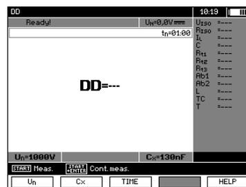
Tasten **F1**  $U_n$ , **F2**  $C_x$  und **F3** **TIME** verwenden, um die gewünschte Spannung, Kapazität sowie die Prüfzeit, (1...60 Min) des Prüflings einzustellen. Durchführung ähnlich wie im Kapitel 3.2.2.
