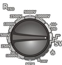
Stellen Sie den Funktionswahlschalter auf die Position **SV**. Das Prüfgerät ist im Spannungsmess-Modus.
