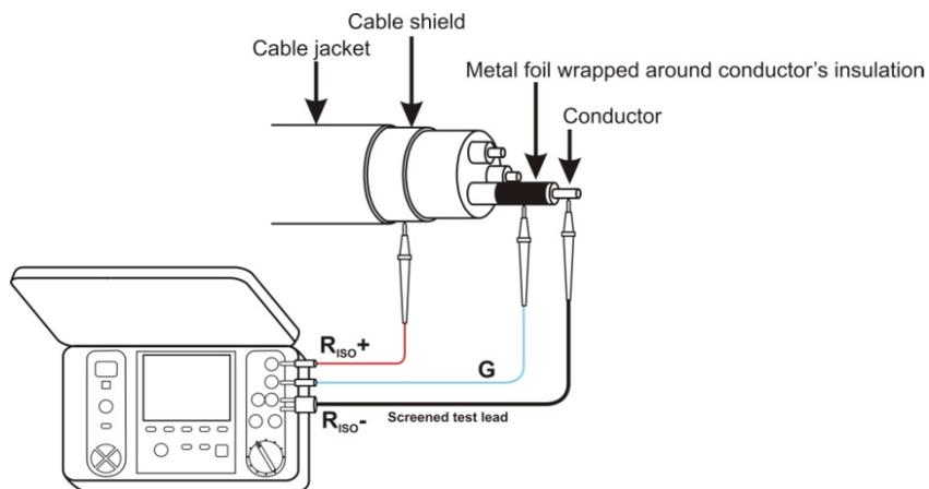
Dasselbe Prinzip sollte angewandt werden, wenn Widerstandsmessungen zwischen zwei Leitern eines Kabels durchgeführt werden. Der **G**-Anschluss sollte dann an dem Leiter angeschlossen werden, welcher nicht in die Messung mit eingebunden ist.
