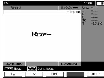
Tasten **F1** **Un**, **F2** **Cx** und **F3** **TIME** verwenden, um die gewünschte Spannung, Kapazität sowie die Prüfzeit des Prüflings einzustellen. Durchführung ähnlich wie im Kapitel 3.2.2.
