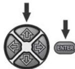
Tasten **↑**, **↓** verwenden, um Drahtlosverbindung AN/AUS zu schalten. Bestätigen der Auswahl durch Drücken von **ENTER**.
