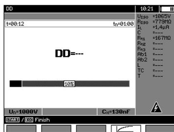
Sowohl während, als auch nach der Messung, kann zwischen dem Display der Ergebnisanzeige und dem Diagramm mit **F4**
