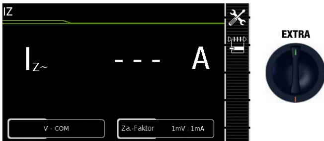
Hier ist eine Zangenstrommessung unabhängig von den Messfunktionen  $R_{PE}$ ,  $I_{PE}$  oder  $I_G$  möglich, z. B. zur Messung von Strömen bei festangeschlossenen Geräten.
