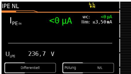
Der Messwert wird innerhalb einer fest vorgegebenen Zeit automatisch ermittelt. Der Bewertungszyklus wird wie folgt visualisiert: der Aktivitätsbalken startet vom linken Displayrand nach rechts. Ist er an der äußersten rechten Position angekommen ist die Bewertung abgeschlossen. Der Prüfablauf wird anschließend automatisch fortgesetzt.
