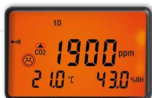
Der **C.A 1510** verfügt über eine zweifarbig beleuchtete große Anzeige, in der die drei Messwerte für CO<sub>2</sub>-Gehalt, Temperatur und rel. Luftfeuchte gleichzeitig erscheinen.
