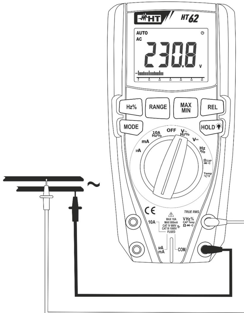
Abb. 3: Verwendung des Gerätes für Wechselspannungsmessung
