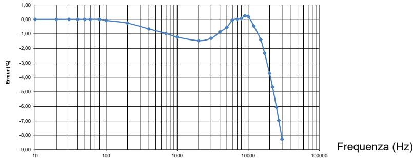
Curva tipica dell'errore di fase a 60 A in funzione della frequenza
