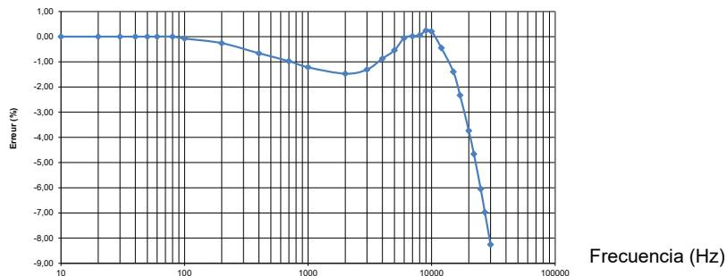
Curva típica del error de fase a 60 A en función de la frecuencia
