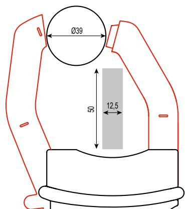
Umschließungsvermögen Durchmesser 39 mm, 2 Kabel Ø 25,4 mm bzw. Schiene 50 x 12,5 mm oder 2 Schienen 50 x 5 mm bzw. 31,5 x 10 mm, 3 Schienen 25 x 8 mm, 2 Schienen 25 x 5 mm
