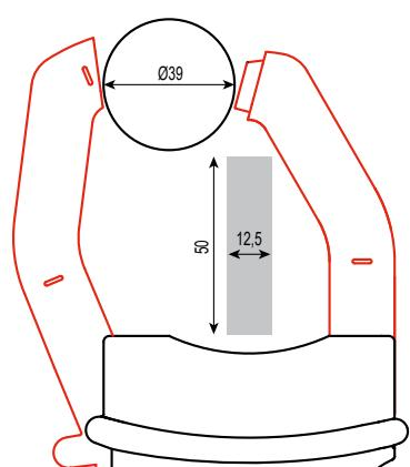
Capacidad para abrazar 39 mm de diámetro, 2 cables de Ø 25,4 mm, una barra de 50 x 12,5 mm o 2 barras de 50 x 5 mm o 31,5 x 10 mm, 3 barras de 25 x 8 mm, 2 barras de 25 x 5 mm
