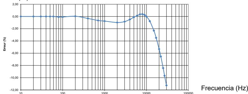
Curva típica del error de fase a 30 A en función de la frecuencia
