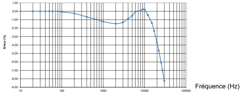
Courbe typique de l'erreur de phase à 60 A en fonction de la fréquence
