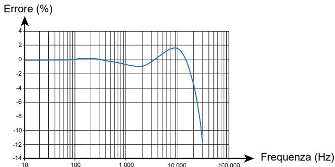
Curva tipica dell'errore di fase a 30 A in funzione della frequenza
