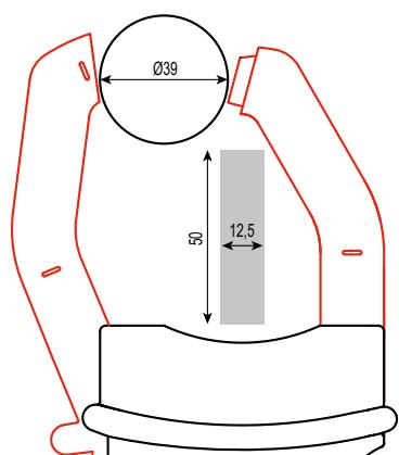
Diametro di serraggio 39 mm di diametro, 2 cavi ( $\varnothing$  245,4 mm) una barra da 50x12,5 mm
