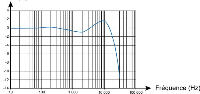
Courbe typique de l'erreur de phase à 30 A en fonction de la fréquence
