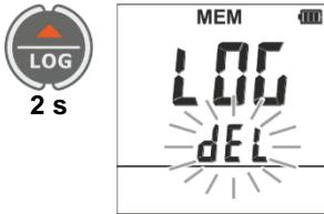
4 Drücken Sie
