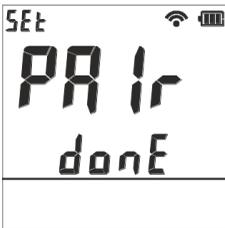
Die erfolgreiche Kopplung wird durch eine Meldung angezeigt. Danach kehrt das Gerät zur Anzeige der Messwerte zurück.
