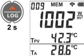
Verwenden Sie die Schaltfläche
