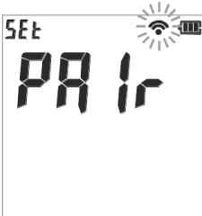
Die Kopplung mit dem Master-Messgerät ist im Gange.
