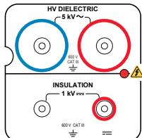
2 bezpečnostní zdírky pro připojení vysokonapěťových pistolí pro dielektrické zkoušky.
