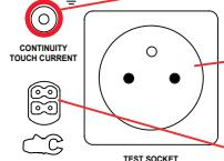
1 Sicherheitsstecker für Sicherheitsleitung für Durchgangsmessungen an der Steckdose und für Berührungsstrommessungen (CA 6163)
