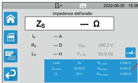
Il rettangolo blu sul display contiene tutti i parametri da configurare. Essi variano secondo le misure.
