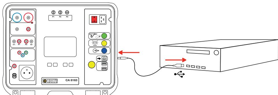
Todas las medidas guardadas en el instrumento se pueden transferir a su PC. La transferencia no elimina los datos guardados.
