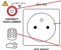
1 toma de seguridad para conectar un cable de seguridad para las medidas de continuidad en una toma y las medidas de corriente de contacto (CA 6163).
