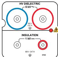
2 prese di sicurezza per allacciare le pistole alta tensione per i test dielettrici.
