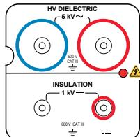
2 защитных гнезда для подключения высоковольтных пробников типа «пистолет» для выполнения испытаний на электрическую прочность.
