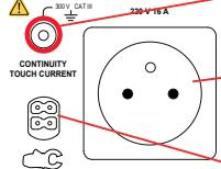
1 защитное гнездо для подключения предохранительного провода для прозвонки электрической цепи розетки и выполнения измерений тока прикосновения (СА 6163).
