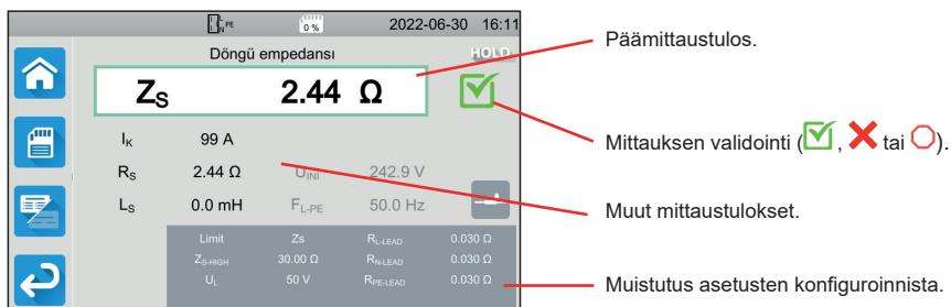
Laite saattaa tuottaa suuria virtuja jatkuvuusmittausten, silmukka- tai linjamittausten, vikavirtasuojatestin tai dielektrisen testin aikana. Laitteen sisäinen lämpötila nousee tällöin.
