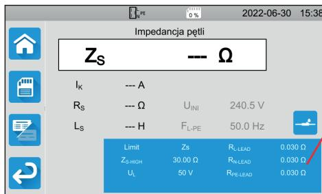
Niebieski prostokąt na wyświetlaczu zawiera wszystkie parametry do skonfigurowania. Różnią się w zależności od pomiarów.
