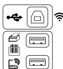
Gniazdo USB typu B do podłączenia do komputera PC w celu przesyłania zarejestrowanych danych lub aktualizacji oprogramowania wewnętrznego.
