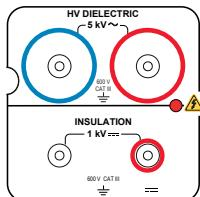
2个安全插座，用于连接高压枪进行介电测试。
