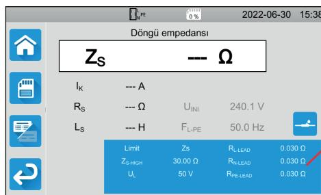
Ekrandaki mavi dikdörtgen, yapılandırılacak tüm parametreleri içerir. Ölçümlere göre değişirler.
