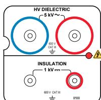
ขัวต่อนิรภัย ๑ ตัวไข้เพื่อต่อ กับปืนไฟฟ้าแรงสูงสำหรับทำการทดสอบไฟอิเล็กทริก
