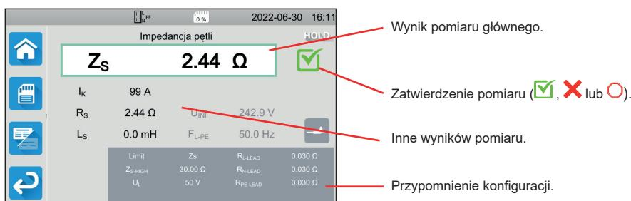
Podczas pomiaru ciągłości, pomiaru impedancji pętli lub linii, testu wyłącznika różnicowego lub testu dielektrycznego, urządzenie może generować wysokie prądy. W wyniku tego procesu wzrasta jego temperatura wewnętrzna. Gdy urządzenie przegrzewa się, aby zapewnić prawidłowe działanie, sygnalizuje to poprzez wyświetlenie symbolu na pasku stanu.
