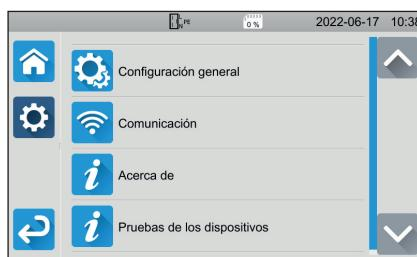
Para configurar el instrumento: elegir el idioma, definir la fecha y la hora así como sus formatos, activar o desactivar el sonido del teclado táctil, activar o desactivar las notificaciones/las alarmas, definir el brillo del display, indicar el estado del comprobador de puerta para las pruebas dieléctricas.
