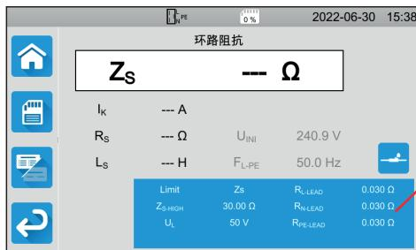
显示器上的蓝色矩形框内包含了所有要配置的参数。这些参数会随着测量而有所改变。
