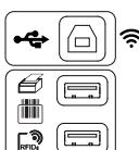
ช่องเสียบ USB Type B เพื่อเชื่อมต่อกับเครื่องพิมพ์เพื่อทำการถ่ายโอนข้อมูลที่บันทึกไว้หรือเพื่ออัปเดตเฟิร์มแวร์
