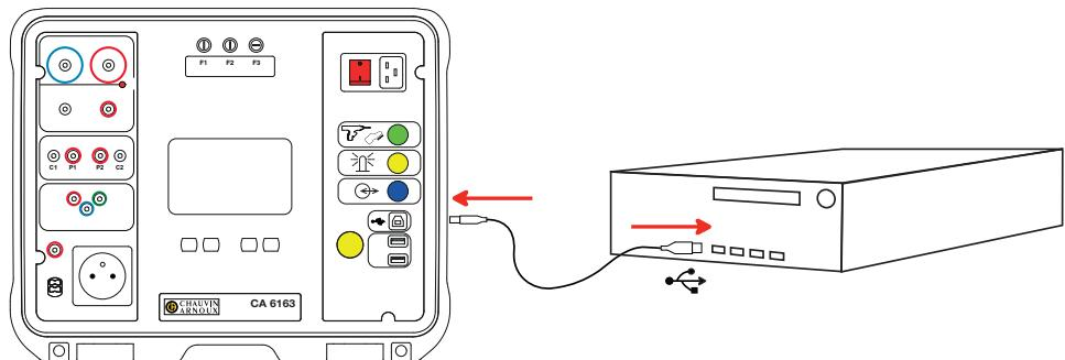
Wszystkie pomiary zapisane w urządzeniu można przenieść do komputera. Transfer nie usuwa zapisanych danych.
