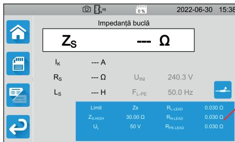
Dreptunghiul albastru de pe afişaj conține toți parametrii de configurat. El variază în funcție de măsurători.
