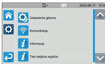
Konfiguracja urządzenia: wybór języka, ustawienie daty i godziny oraz ich formatów, włączanie lub wyłączanie dźwięku klawiatury dotykowej, włączanie lub wyłączanie powiadomień/alarmów, dostosowanie jasności wyświetlacza, wskazanie stanu testera drzwi dla testów dielektrycznych.
