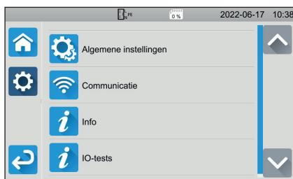
Voor het configureren van het apparaat: kies de taal, stel de datum en de tijd en het formaat hiervan in, schakel het geluid van het aanraaktoetsenbord in of uit, schakel de notificaties / de alramen in of uit, stel de lichtsterkte van de display in, geef de toestand aan van de deurcontrole voor de diëlektrische tests.
