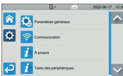
Pour configurer l'appareil : choisir la langue, régler la date et l'heure ainsi que leurs formats, activer ou désactiver le son du clavier tactile, activer ou désactiver les notifications / les alarmes, régler la luminosité de l'afficheur, indiquer l'état du vérificateur de porte pour les tests diélectriques.
