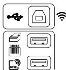
USB-Anschluss Typ B für einen PC-Anschluss, zur Übertragung von gespeicherten Daten oder zum Aktualisieren der Firmware.
