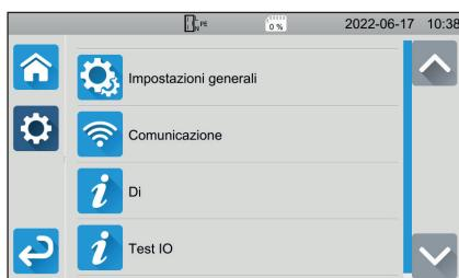
Per configurare lo strumento: scegliere la lingua, impostare la data, l'ora e i loro formati, attivare o disattivare il suono della tastiera tattile, attivare o disattivare le notifiche / gli alarmi, impostare la luminosità del display, indicare lo stato del verificatore della porta per i test dielettrici.
