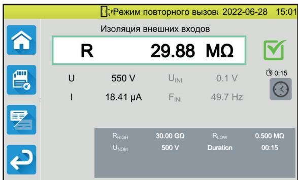
Результат измерения отображается в том виде, в котором он был при сохранении, за исключением строки состояния, которая подсвечивается желтым.
