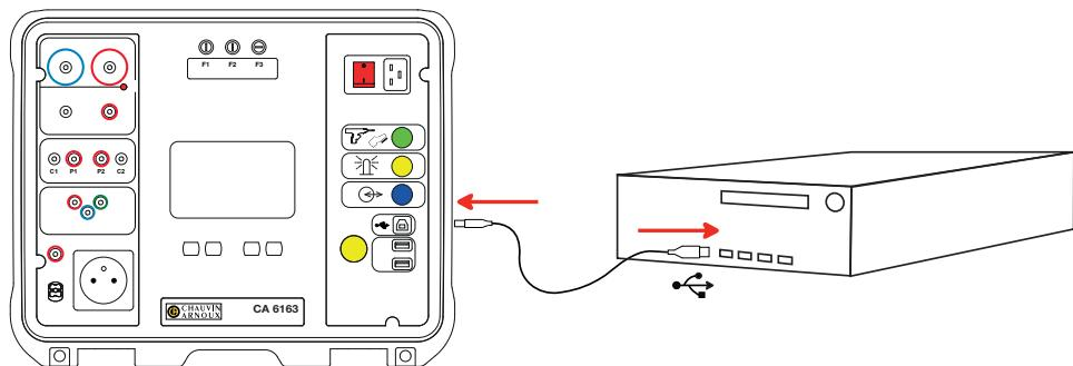
Všechna měření uložená v přístroji lze přenést do počítače. Přenosem se zaznamenaná data nevymažou.
