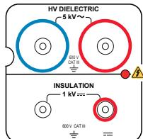
2 Sicherheitsbuchsen für Hochspannungs-Pistolenprüf spitzen für dielektrische Prüfungen
