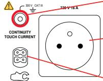
1 prise de sécurité pour brancher un cordon de sécurité pour et les mesures de continuité sur prise et les mesures de courant de contact (CA 6163).
