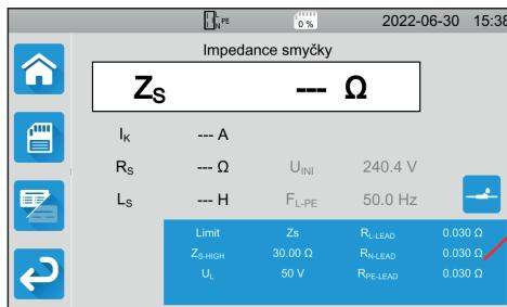
Modrý obdélník na displeji obsahuje všechny parametry, které je třeba nakonfigurovat. Liší se podle měření.
