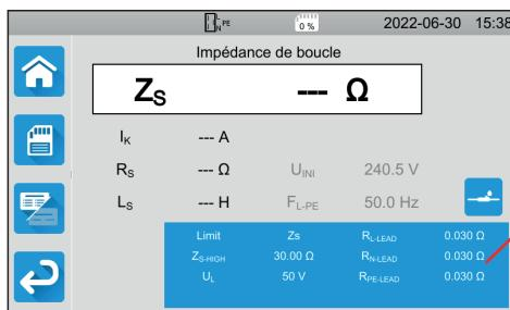
Le rectangle bleu sur l'afficheur contient tous les paramètres à configurer. Ils varient suivant les mesures.
