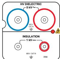
2 tomas de seguridad para conectar las pistolas de alta tensión para las pruebas dieléctricas.
