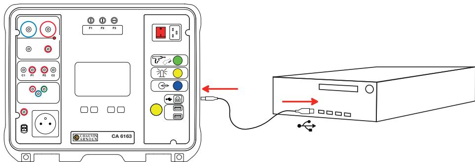
Alle im Gerät gespeicherten Messungen können auf den PC übertragen werden. Bei der Übertragung werden die gespeicherten Daten nicht gelöscht.
