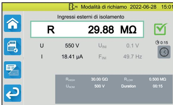
La misura si visualizza com'era nell'ultima registrazione, ma la barra di stato è gialla.
