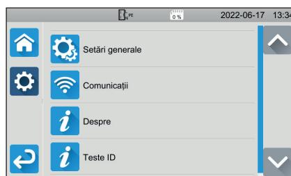
Pentru configurarea aparatului: alegeti limba, potriviti data, ora si formatele acestora, activati sau dezactivati sunetul tasturii tactile, activati ori dezactivati notificarile/alarmele, reglati luminozitatea afisajului, indicați starea verificatorului de usă pentru testele dielectrice.
