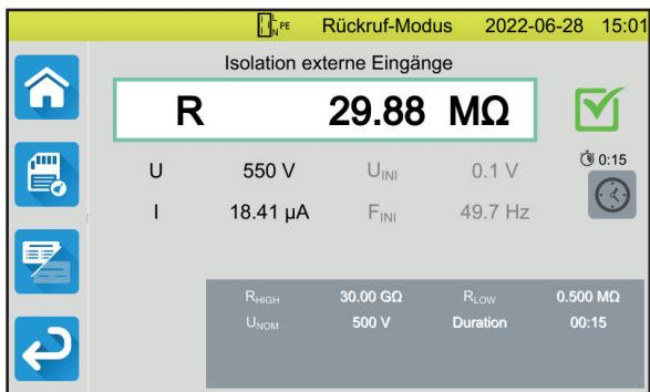
Die Messung wird genauso angezeigt, wie sie aufgezeichnet wurde, außer dass die Statusleiste gelb ist.
