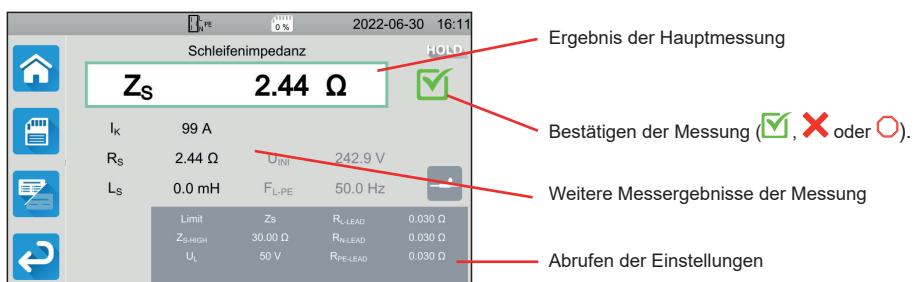
Bei Durchgangsmessungen, Schleifen- oder Leitungsimpedanzmessungen, FI-Schutzschalter- und dielektrischen Prüfungen kann das Gerät hohe Ströme erzeugen. Dadurch steigt die Innentemperatur des Geräts an.
