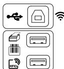
Разъем USB типа В для подключения к ПК для передачи записанных данных или обновления встроенного программного обеспечения.
