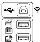
USB-aansluiting type B voor aansluiting op een PC om de opgeslagen gegevens door te sturen of de ingebouwde software te updaten.
