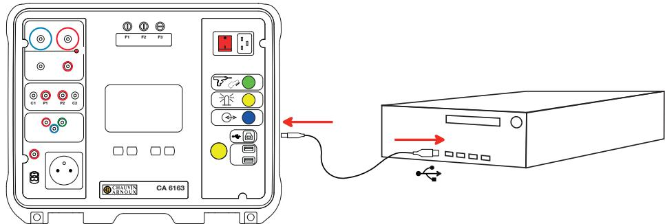
ท่านสามารถถ่ายโอนค่าที่วัดได้ทั้งหมดที่บันทึกไว้ในเครื่องมือวัดไปที่เครื่องพิมพ์ได้ การถ่ายโอนข้อมูลจะไม่ลบข้อมูลที่บันทึกไว้ หากต้องการใช้งานซอฟต์แวร์ MTT โปรดดูวิธีใช้หรือคู่มือผู้ใช้งาน
