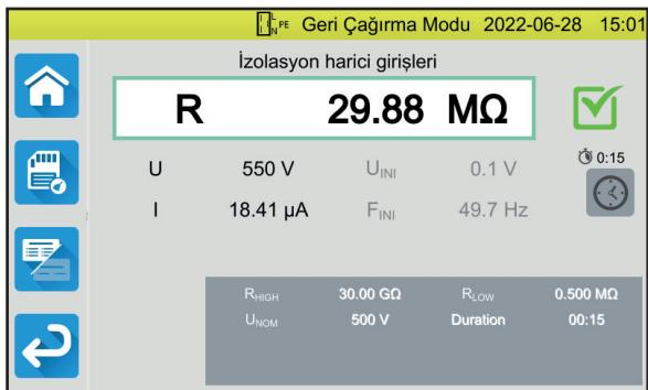
Mittaus näytetään siinä muodossa kuin se tallennettiin, paitsi että tilapalkki on keltainen.
