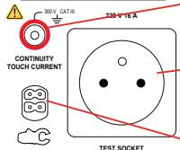
1 säkerhetsingång för anslutning av säkerhetskabel för kontinuitetsmätningar på uttag och kontaktströmmätningar (CA 6163).
