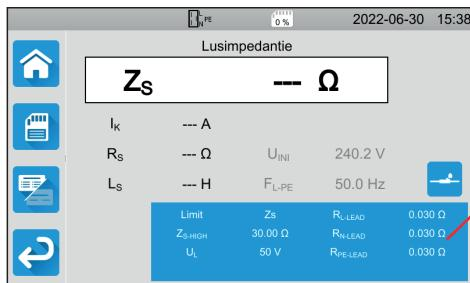
De blauwe driehoek op de display bevat alle te configureren parameters. Deze variëren aan de hand van de metingen.
