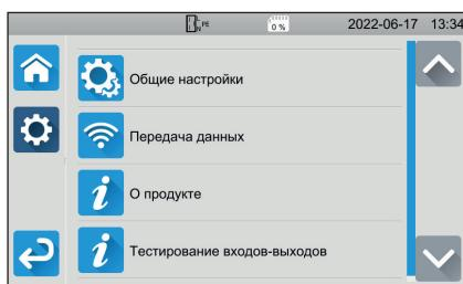
Настройка прибора: выбор языка, настройка даты и времени, а также их форматов, включение или отключение звука сенсорной клавиатуры, включение или отключение уведомлений/звуковых сигналов, регулировка яркости дисплея, указание состояния устройства проверки закрывания дверцы для выполнения испытаний на электрическую прочность.
